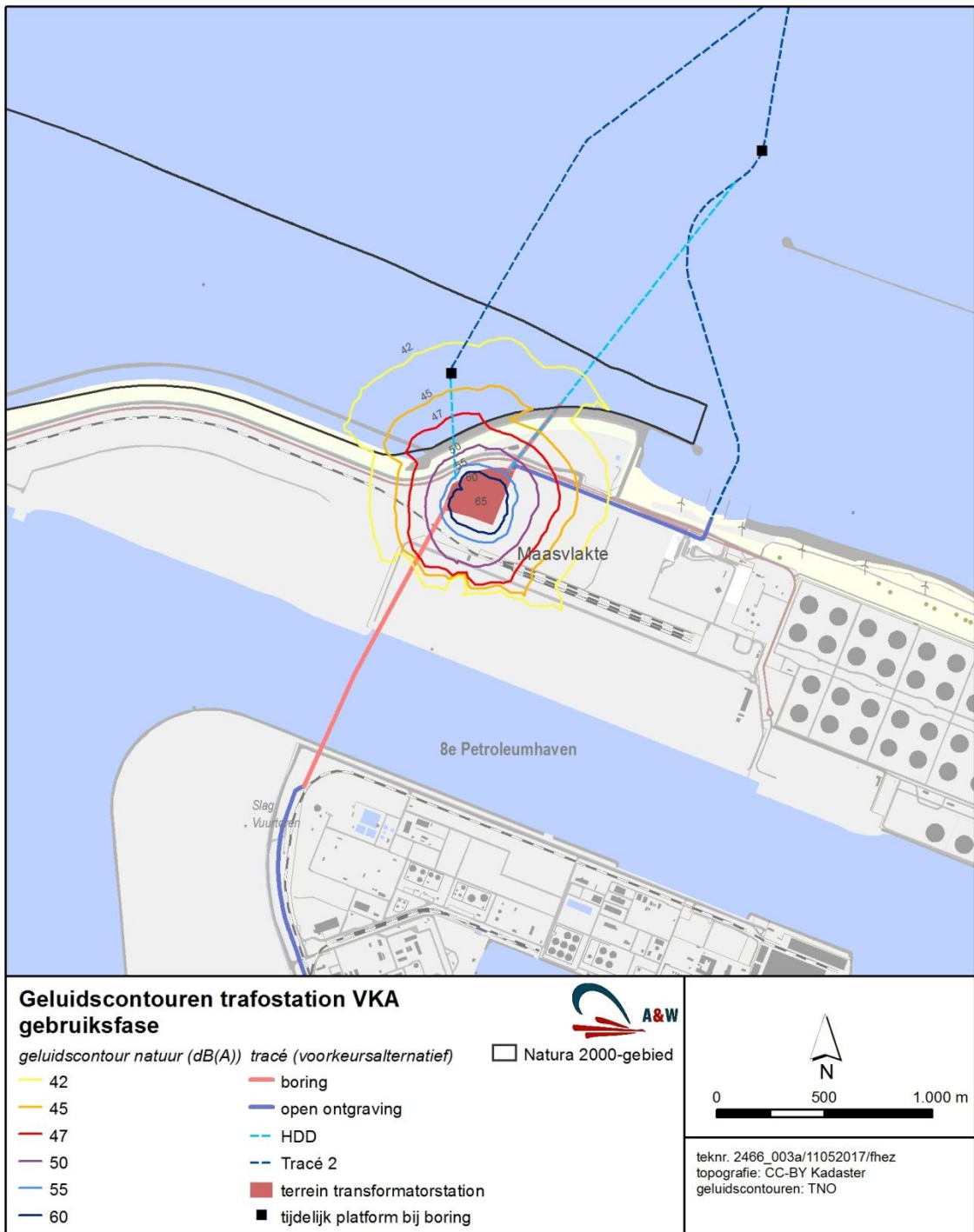
Afbeelding 6.6 Gebruiksfase: Geluidscontouren transformatorstation in de gebruiksfase
