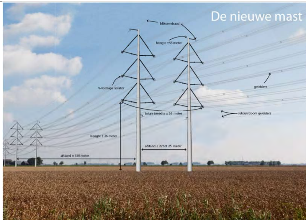
Figuur 1.2 Kenmerken van de nieuwe bipolemast.
