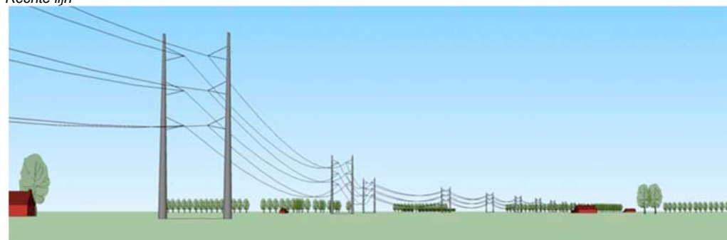
Lijn met een richtingsverandering van 20 graden
