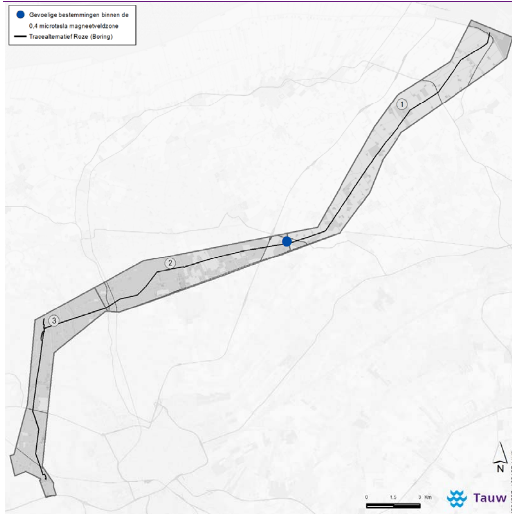
Figuur 11.9 Gevoelige bestemmingen in de indicatieve magneetveldzone van alternatief Roze (gestuurde boring)
