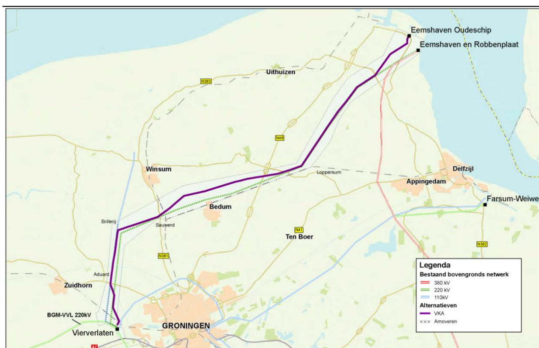
Figuur 1.1 Overzichtskartaal met de nieuw te bouwen 380 kV-hoogspanningsverbinding (voorkeurstracé in paars) en de bestaande 110 en 220kV-verbindingen (blauw resp. groen).
