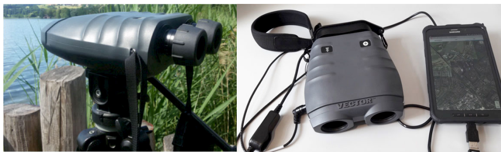
Figuur 2.1 De Vectronix Vector 21 Aero Laser Range Finder met de tablet (rechts) waarop hij in het veld was aangesloten.
