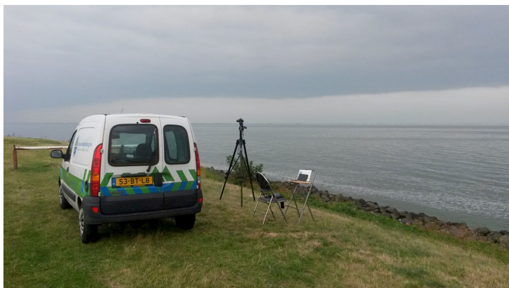
Figuur 2.3 Materiaal opstelling tijdens het uitvoeren van hoogtemetingen en panoramascans vanaf de Afsluitdijk (locatie 'west').
