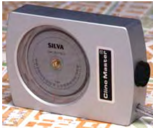
Figuur 2.3 Inclinometer waarmee hoeken ten opzichte van de horizon kunnen worden bepaald om de waarneemstripbanden af te bakenen.
