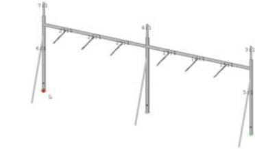
220kV Dubbel Ijnpортааl station VVL380 (4101611-035-418)
