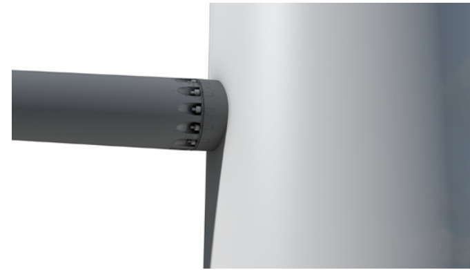
ingekaste bevestiging > bevestiging is zichtbaar van buiten maar valt niet buiten de brace. De verbindingsplaat is gelast op de mast.
