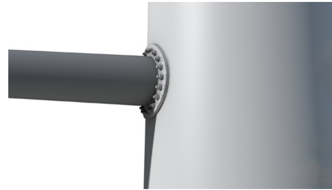
minimale flens > de verbinding zal niet verder uitsteken dan 0,03 \cdot D (D= diameter t.p.v. aansluiting), met een minimum van 25mm. De verbindingplaat is conisch zodat hij gelijkmatig uitsteekt aan alle zijdes De bouten steken niet verder uit de verbindingsplaat dan 25mm.
