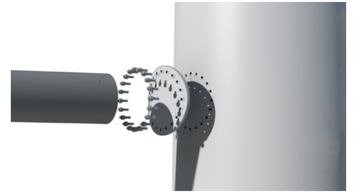
minimale flens > de verbinding zal niet verder uitsteken dan 0,03 \cdot D (D= diameter t.p.v. aansluiting), met een minimum van 25mm. De verbindingplaat is conisch zodat hij gelijkmatig uitsteekt aan alle zijdes De bouten steken niet verder uit de verbindingsplaat dan 25mm.
