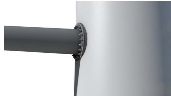
minimale verbindingsplaat > verbindingsplaat is vlak en steekt uit, de onderzijde gelijk met de mast. boven en aan de zijkant mag hij niet verder uitsteken dan 0,03 \cdot D (D= diameter t.p.v. aansluiting), met een minimum van 100mm.
