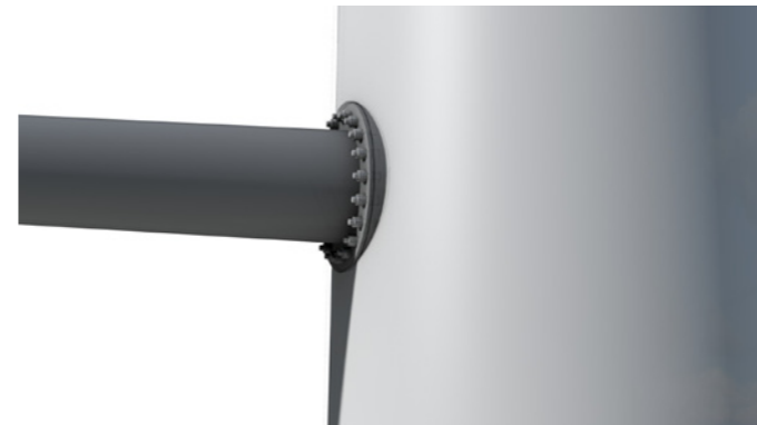
minimale verbindingplaat > verbindingplaat is vlak en steekt uit, de onderzijde gelijk met de mast. boven en aan de zijkant mag hij niet verder uitsteken dan 0,03 \cdot D (D= diameter t.p.v. aansluiting), met een minimum van 100mm.
