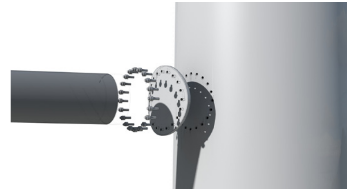
minimale flens > de verbinding zal niet verder uitsteken dan 0,03 \cdot D (D= diameter t.p.v. aansluiting), met een minimum van 25mm. De verbindingplaat is conisch zodat hij gelijkmatig uitsteekt aan alle zijdes De bouten steken niet verder uit de verbindingplaat dan 25mm.
