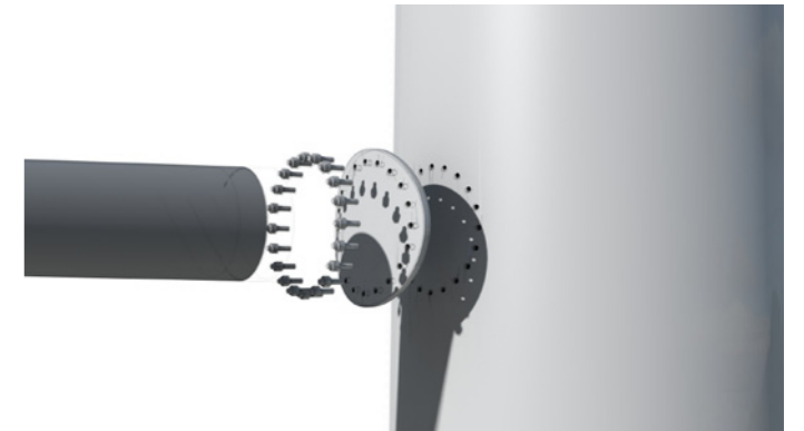
minimale flens > de verbinding zal niet verder uitsteken dan 0,03 \cdot D ( D = \text{diameter t.p.v. aansluiting} ), met een minimum van 25mm. De verbindingplaat is conisch zodat hij gelijkmatig uitsteekt aan alle zijdes De bouten steken niet verder uit de verbindingsplaat dan 25mm.
