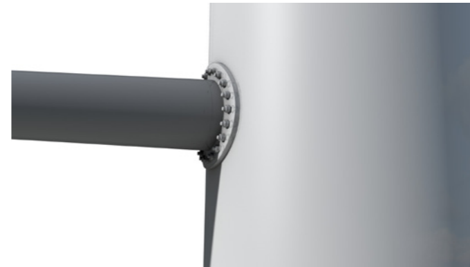
minimale flens > de verbinding zal niet verder uitsteken dan 0,03 \cdot D ( D = \text{diameter t.p.v. aansluiting} ), met een minimum van 25mm. De verbindingplaat is conisch zodat hij gelijkmatig uitsteekt aan alle zijdes De bouten steken niet verder uit de verbindingsplaat dan 25mm.
