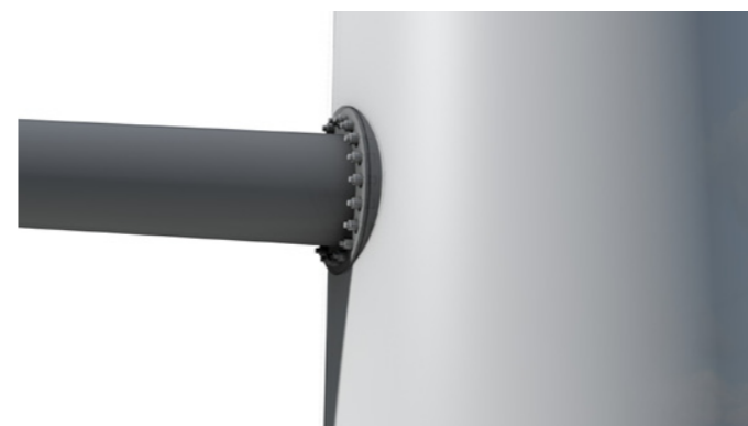
minimale verbindingsplaat > verbindingsplaat is vlak en steekt uit, de onderzijde gelijk met de mast. boven en aan de zijkant mag hij niet verder uitsteken dan 0,03 \cdot D ( D = \text{diameter t.p.v. aansluiting} ), met een minimum van 100mm.
