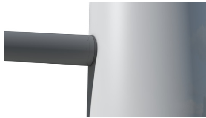
geen zichtbare verbinding, brace is aangelast
