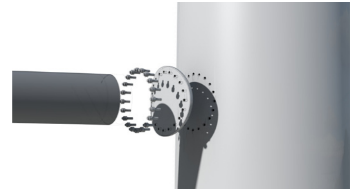
minimale flens > de verbinding zal niet verder uitsteken dan 0,03 \cdot D (D= diameter t.p.v. aansluiting), met een minimum van 25mm. De verbindingplaat is conisch zodat hij gelijkmatig uitsteekt aan alle zijdes De bouten steken niet verder uit de verbindingsplaat dan 25mm.
