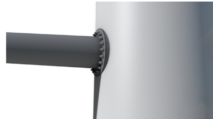
minimale verbindingsplaat > verbindingsplaat is vlak en steekt uit, de onderzijde gelijk met de mast. boven en aan de zijkant mag hij niet verder uitsteken dan 0,03 \cdot D (D= diameter t.p.v. aansluiting), met een minimum van 100mm.
