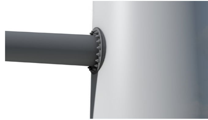
minimale verbindingplaat > verbindingplaat is vlak en steekt uit, de onderzijde gelijk met de mast. boven en aan de zijkant mag hij niet verder uitsteken dan 0,03 \cdot D ( D = diameter t.p.v. aansluiting), met een minimum van 100mm.
