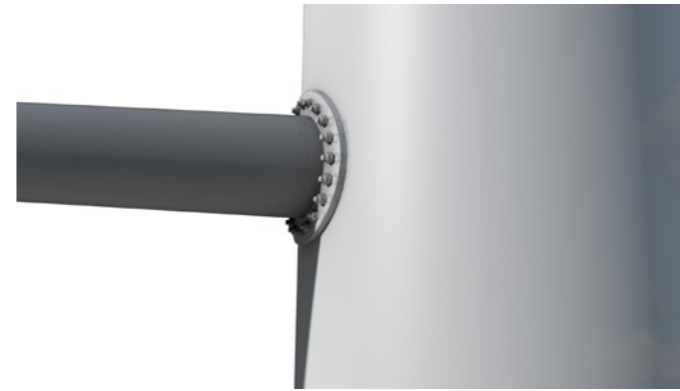
minimale flens > de verbinding zal niet verder uitsteken dan 0,03 \cdot D ( D = diameter t.p.v. aansluiting), met een minimum van 25mm. De verbindingplaat is conisch zodat hij gelijkmatig uitsteekt aan alle zijdes De bouten steken niet verder uit de verbindingplaat dan 25mm.
