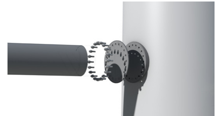
minimale verbindingsplaat > verbindingsplaat is vlak en steekt uit, de onderzijde gelijk met de mast. boven en aan de zijkant mag hij niet verder uitsteken dan 0,03 * D (D= diameter t.p.v. aansluiting), met een minimum van 100mm.
