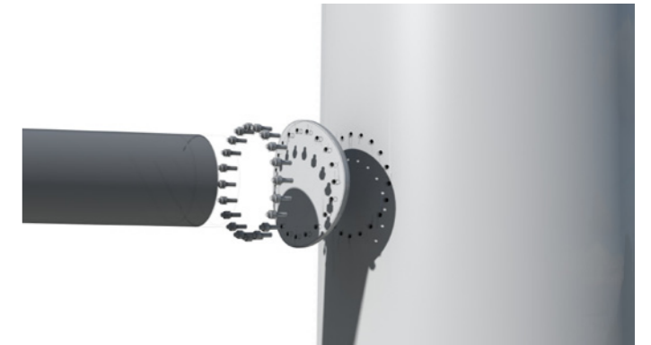
minimale flens > de verbinding zal niet verder uitsteken dan 0,03 * D (D= diameter t.p.v. aansluiting), met een minimum van 25mm. De verbindingplaat is conisch zodat hij gelijkmatig uitsteekt aan alle zijdes De bouten steken niet verder uit de verbindingsplaat dan 25mm.
