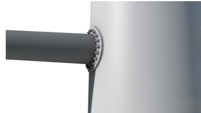
minimale flens > de verbinding zal niet verder uitsteken dan 0,03 * D (D= diameter t.p.v. aansluiting), met een minimum van 25mm. De verbindingplaat is conisch zodat hij gelijkmatig uitsteekt aan alle zijdes De bouten steken niet verder uit de verbindingsplaat dan 25mm.
