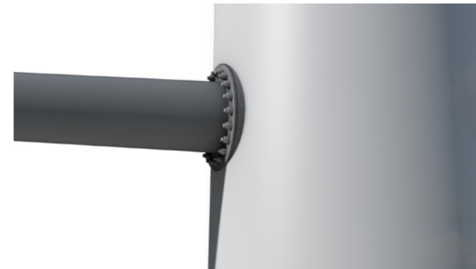
minimale verbindingsplaat > verbindingsplaat is vlak en steekt uit, de onderzijde gelijk met de mast. boven en aan de zijkant mag hij niet verder uitsteken dan 0,03 * D (D= diameter t.p.v. aansluiting), met een minimum van 100mm.
