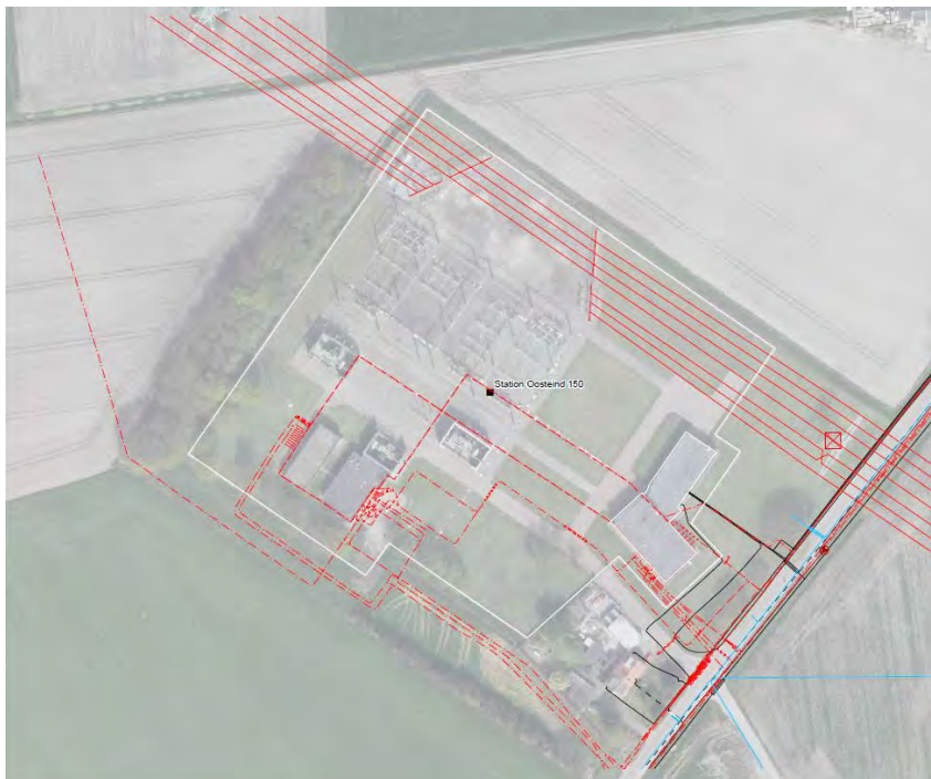
Afbeelding 24 – Kabels en leidingen OTD150
