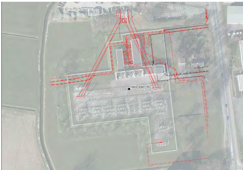
Afbeelding 15 – Kabels en leidingen ETN150
