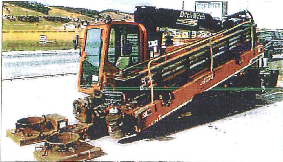
Afbeelding: 50 tons boor-rig Van Vulpen
