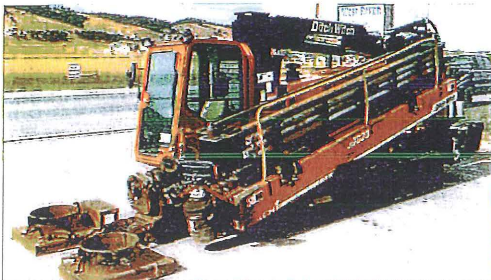
Afbeelding: 50 tons boor-rig Van Vulpen
