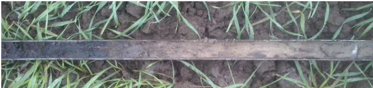
Figuur 6: Foto van boring 26 met veen(links) op doorworteld dekzand (midden) met rechts daarvan het grijze ongeoxideerde zand van de C-horizont
