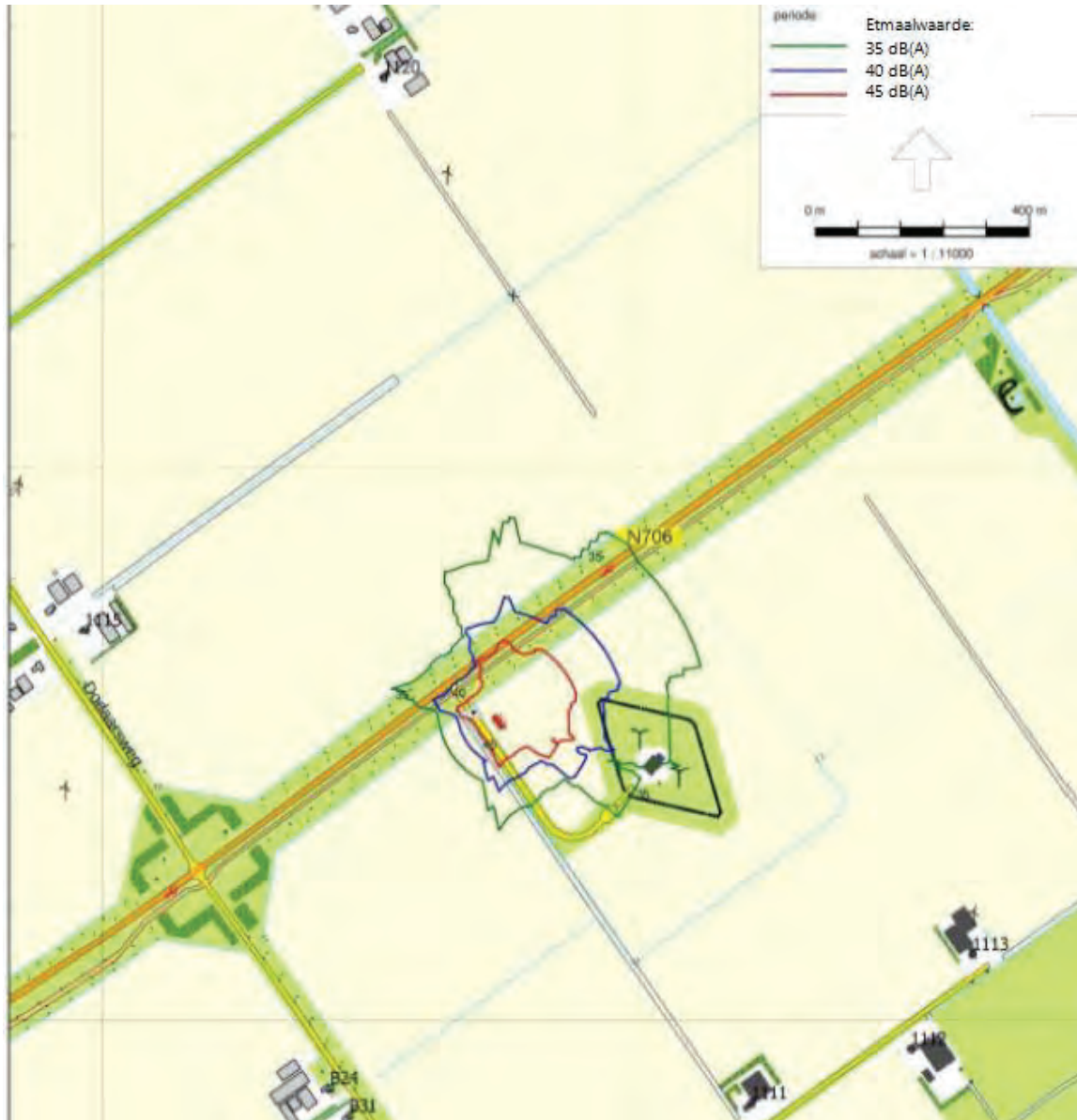
Figuur 5.2 Etmaalwaarde-contouren voor het onderstation
