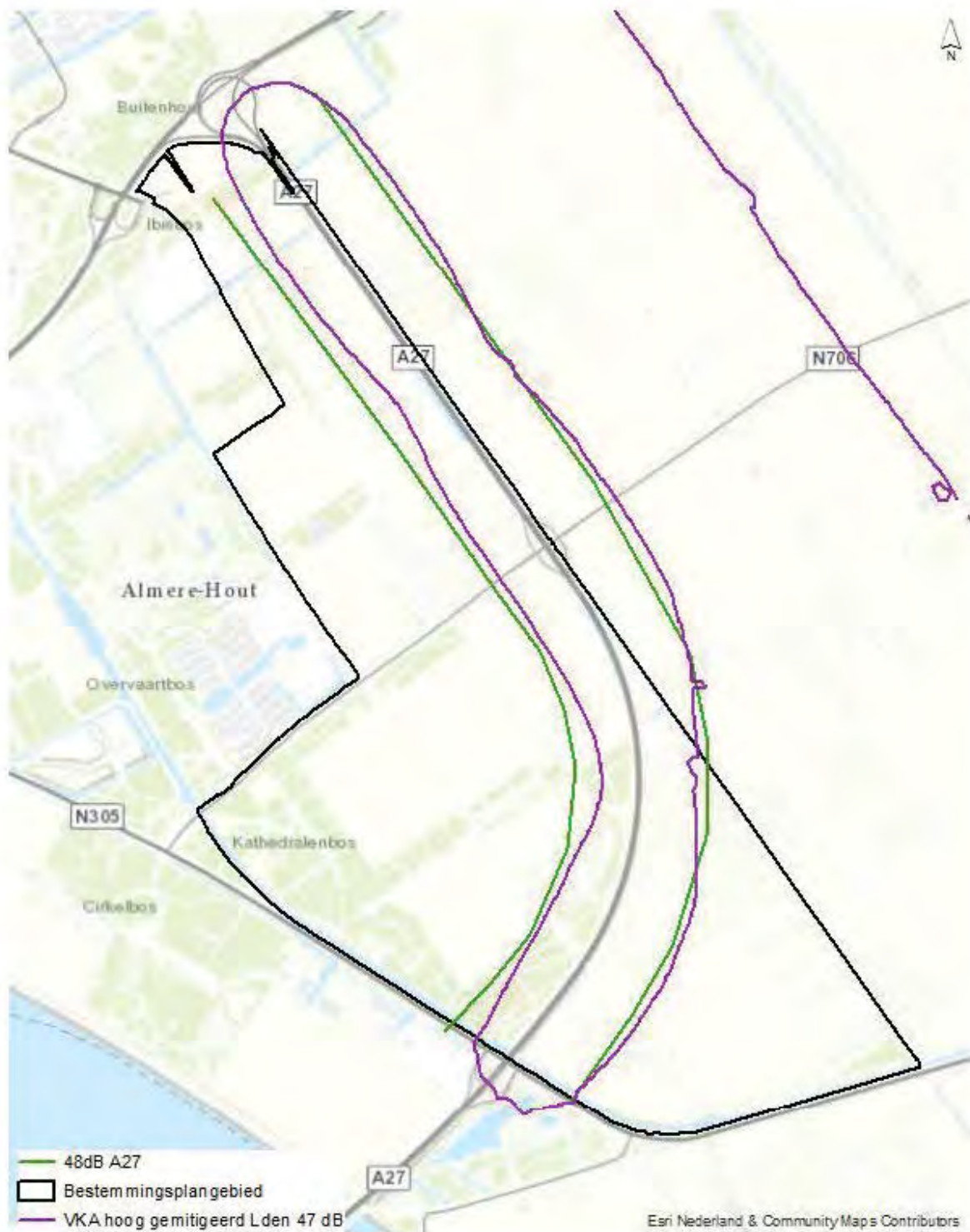
Figuur II.1 L_{den} geluidscontour VKA Windpark Zeewolde en de contour L_{den} 48 dB van de Rijksweg A 27 (Bron: Witteveen+Bos en Pondera, 2017)
