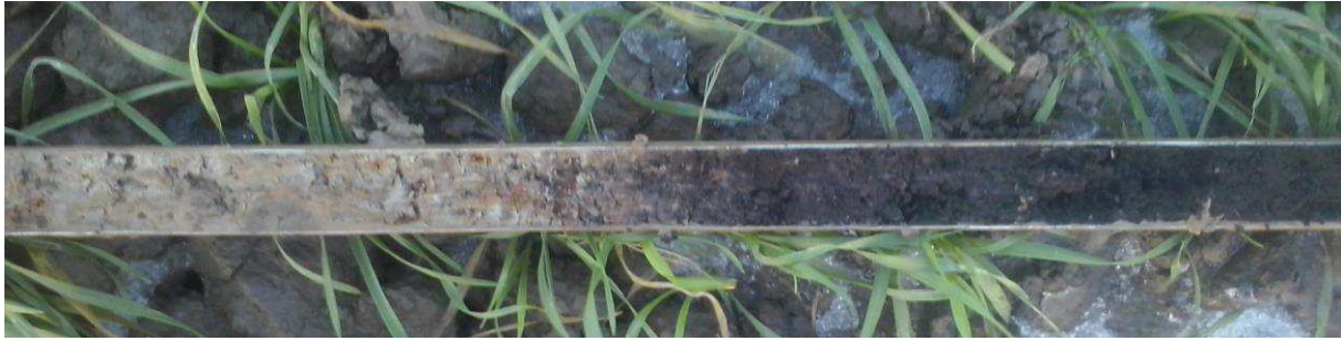
Figuur 9: Foto van boring 61 met in het midden de geïrodeerde top van het veen (rechts)
