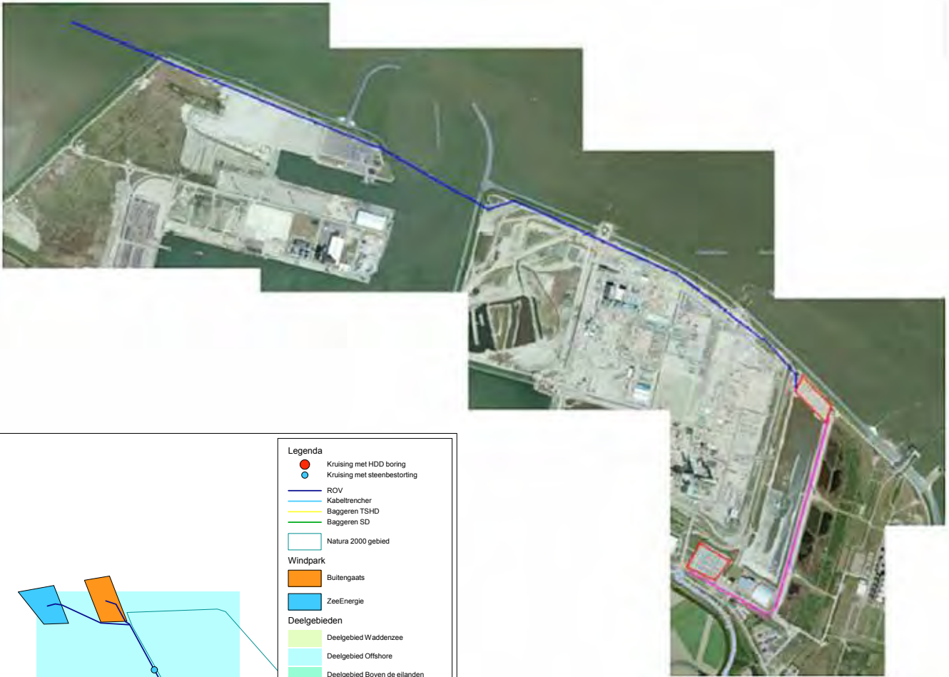
Figuur 3.2 Detail tracé Eemshaven. De blauwe lijn is het landtracé tot het schakel- en transformatorstation (rood omlijnd), roze lijn is het landtracé tot het hoogspanningsstation Oudeschip (rood omlijnd).
