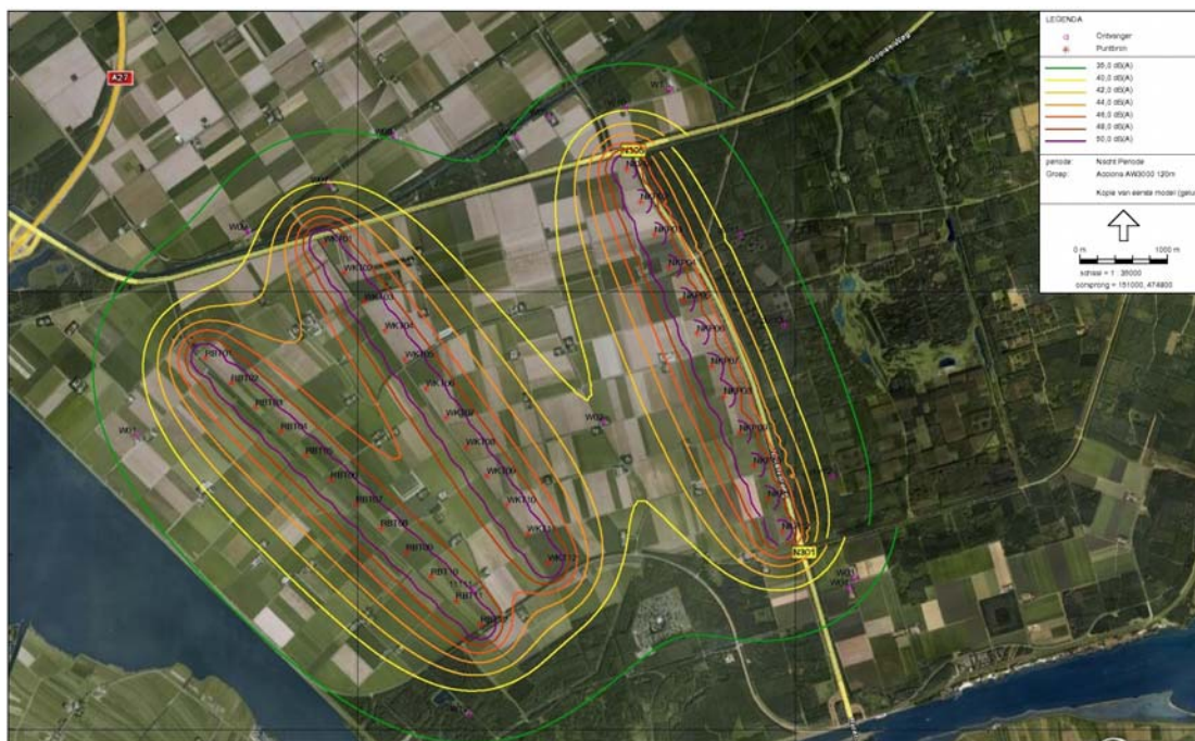
Figuur 21: Acciona AW3000, WNC-contouren met meethoogte 1,5 meter ter plaatse van milieubeschermingsgebied voor stilte en 5 meter buiten het milieubeschermingsgebied. Het verspringen van de contouren is een gevolg van het verschil in meethoogte.
