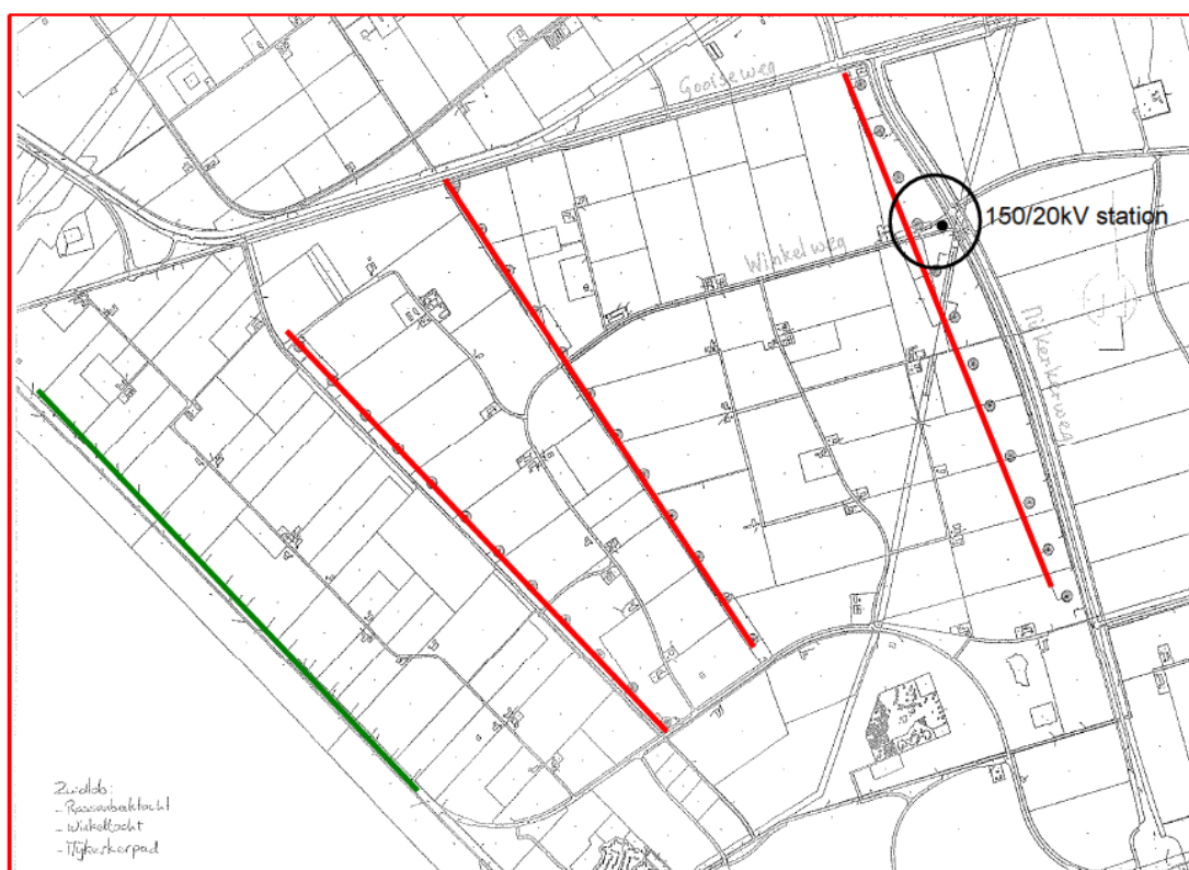
Figuur S1: aanduiding van de drie lijnopstellingen (in rood aangeduid) en het onderstation (aangeduid met 150/20kVstation). De groene lijn duidt de bestaande windturbineopstelling nabij de Eemmeerdijk aan.
