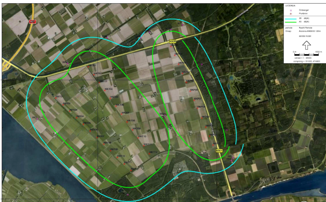
Figuur 19: Acciona AW3000, WNC-contouren van 35 en 40 dB(A) met meethoogte 1,5 meter ter plaatse van milieubeschermingsgebied voor stilte en 5 meter buiten het milieubeschermingsgebied. Het verspringen van de contouren is een gevolg van het verschil in meethoogte.
