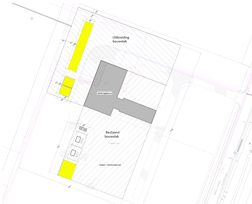
Figuur 1.3 Globale lay-out schakelstation mogelijke toekomstige situatie (in geel de maximale opties voor nieuwe bebouwing)
