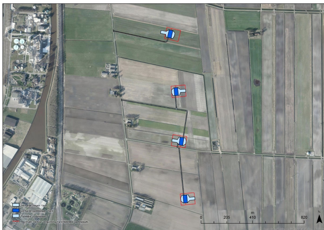
Figuur 4 Locatie verharde toegangswegen, tijdelijke kraanopstelplaatsen (lichtblauw) en permanente opstelplaatsen windturbines 28 t/m 31 in het middendeel van Windpark N33 (bron: Pondera Consult).
