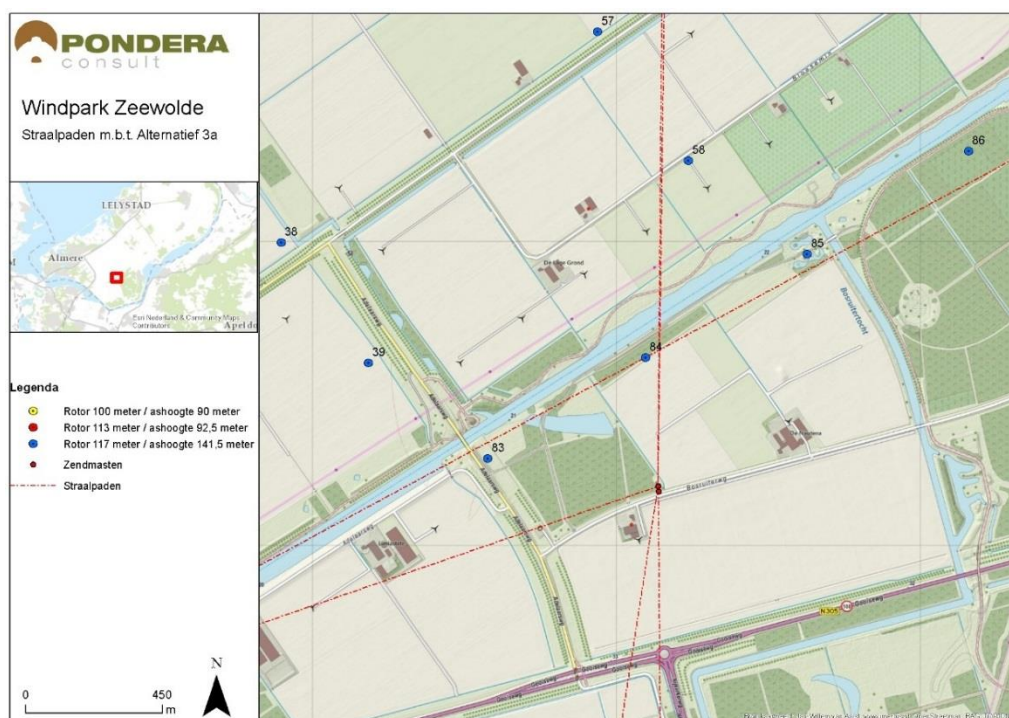
Figuur 12.4 Weergave van een aantal windturbines (alternatief 3a) met betrekking tot straalpaden.
