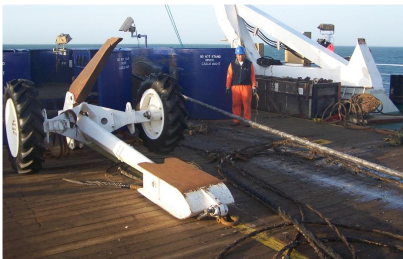
Figuur 5 : Dreg op wielen aan boord van een kabel schip
