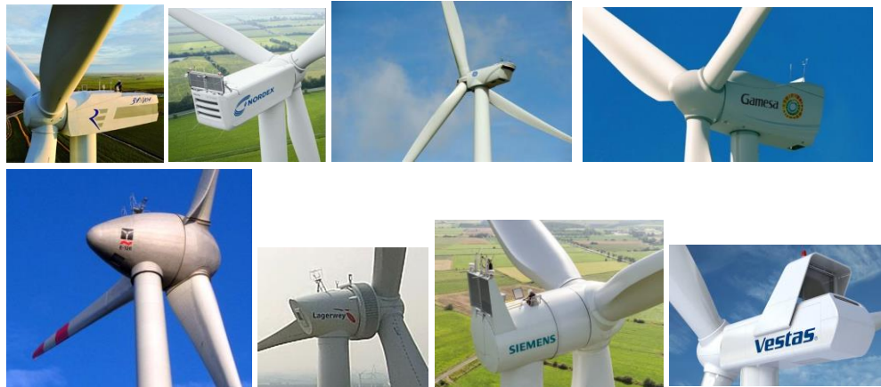
Figuur 4.1 Verschillende verschijningsvormen van de gondel van een windturbine
