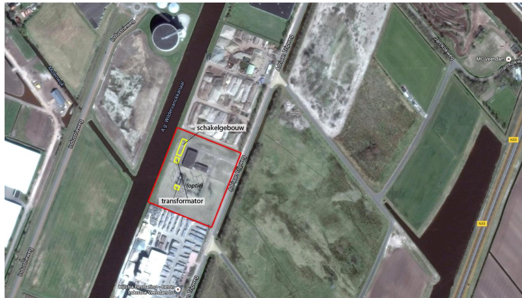
Figuur 1.2 Terrein van het schakelstation Veendam (rood omlijnd) en benodigde ruimte voor uitbreiding van het schakelstation (geel omlijnd) (beide globaal weergegeven)
