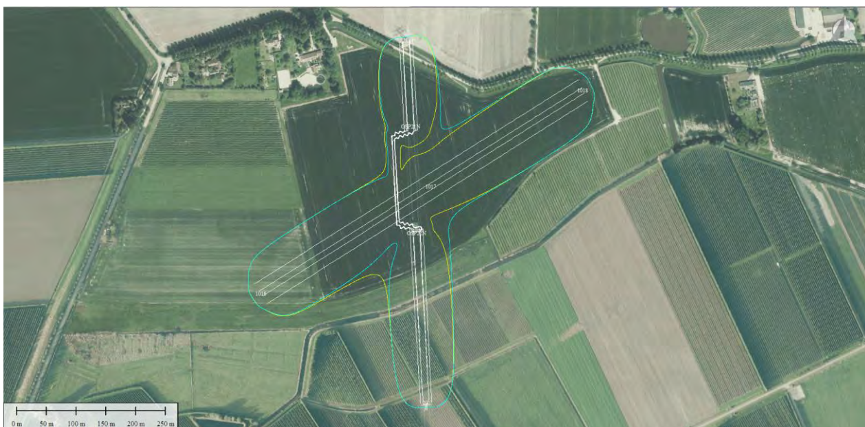
Figuur 5: Weergave 0,4 microtesla magneetveldcontour nabij opstijgpunt 22N
