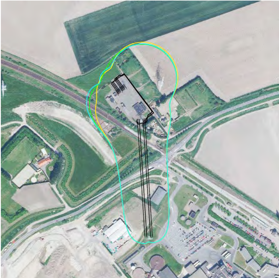
Figuur 4: weergave alle contouren "Cumulatieve magneetveld" 0,4 microtesla station Kruiningen(150kV) vóór aanpassing
