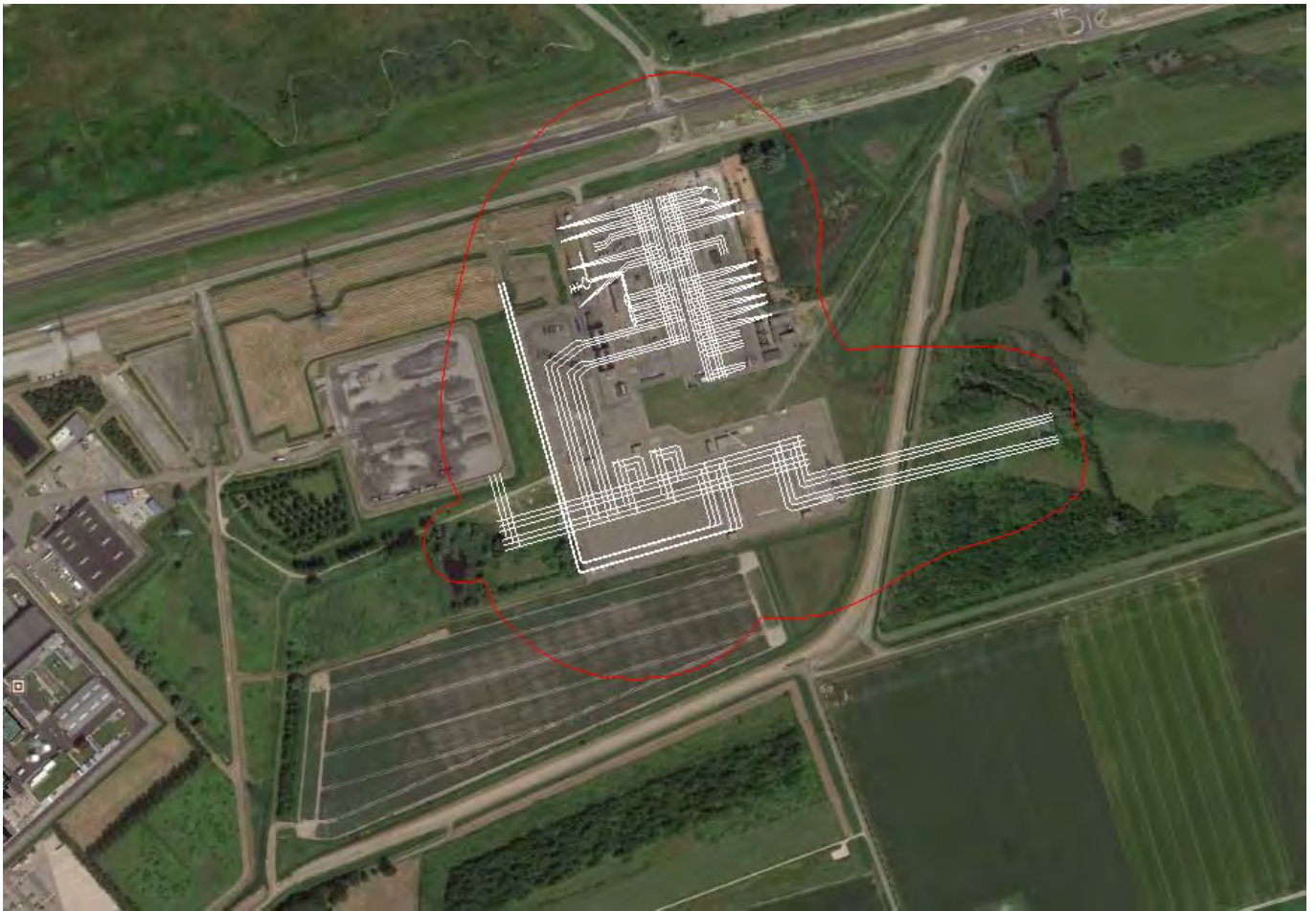
Figuur 6 "cumulatieve magneetveld" 0,4 microtesla contour station Borssele na railverlenging en toevoeging veld 103 t.b.v. EPZ
