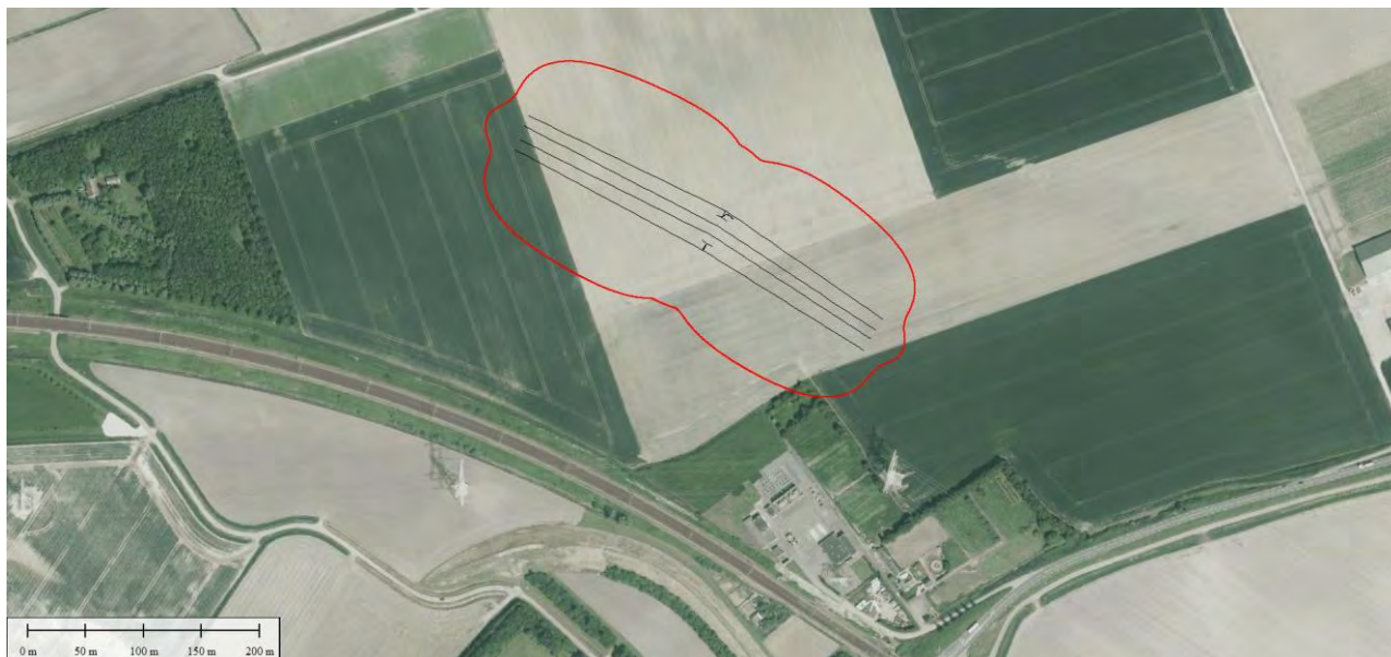
Figuur 2: Weergave "Cumulatieve magneetveld" 0,4 microteslacontour opstijgpunt 1066
