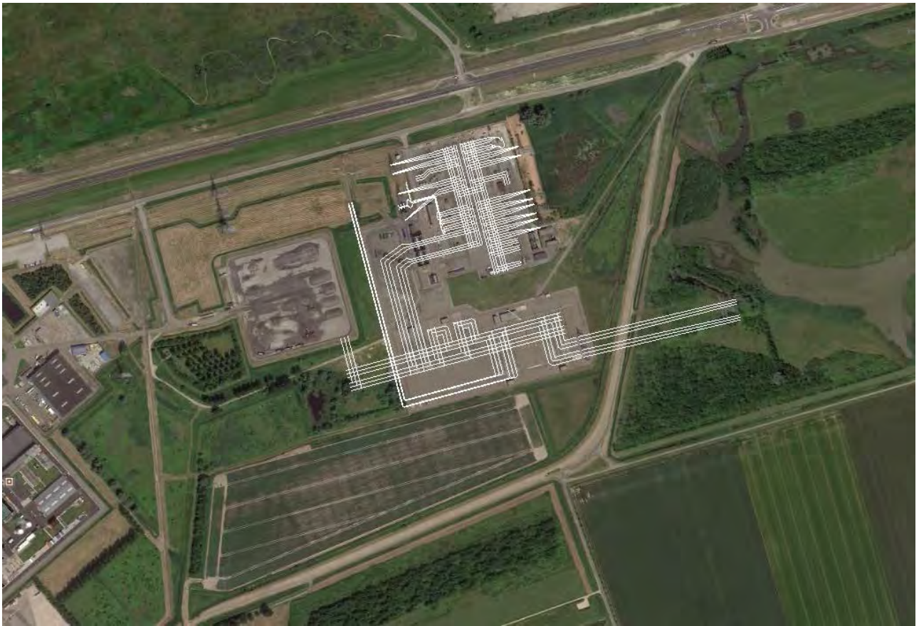
Figuur 2 Variant 2, station Borssele met verlenging 380 kV rails en toevoeging veld 103 t.b.v. EPZ
