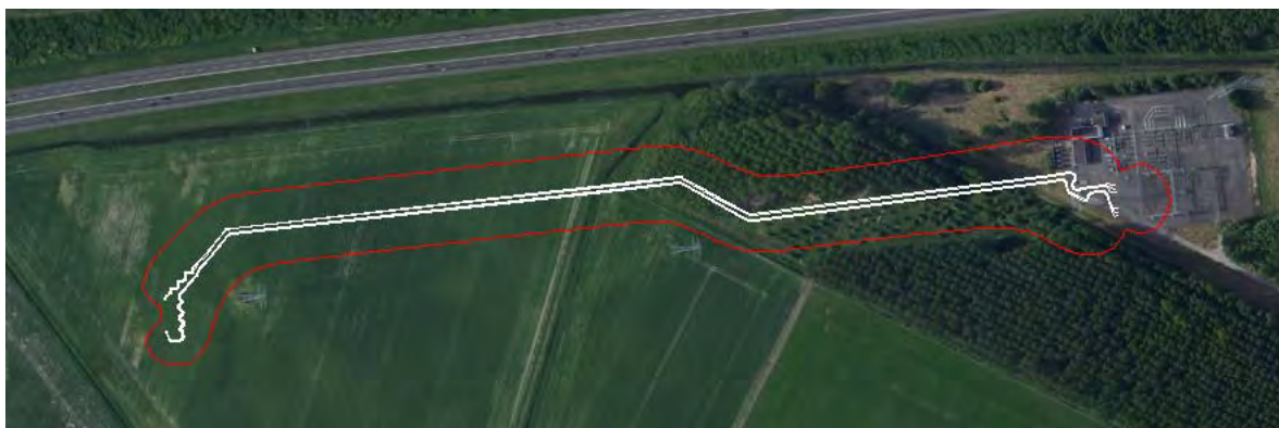
Figuur 2 "Rilland West" Magneetveld contour 0,4 uT
