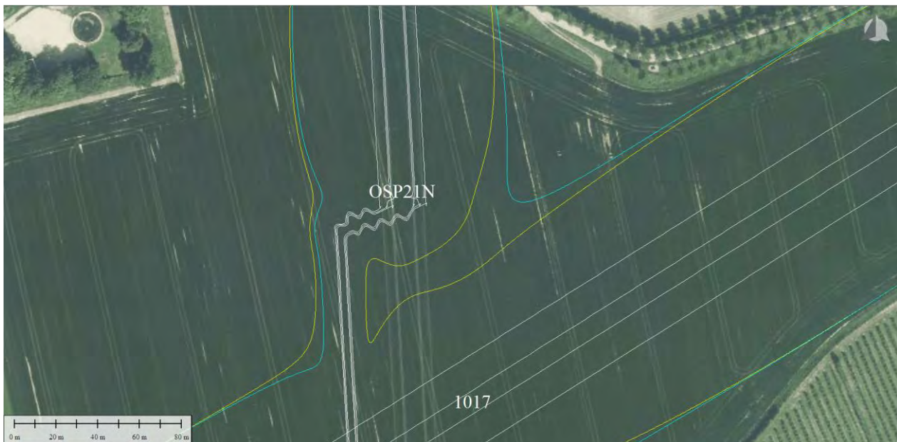
Figuur 4: Weergave 0,4 microtesla magneetveldcontouren opstijgpunt 21N
