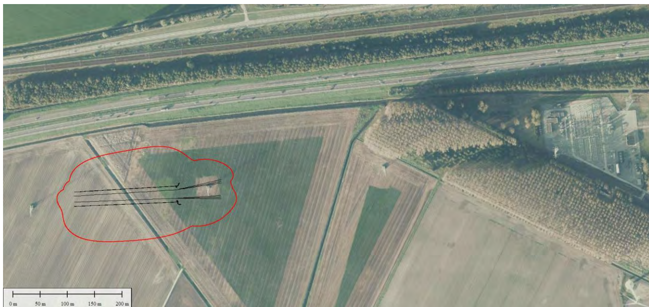
Figuur 2: Weergave "Cumulatieve magneetveld" 0,4 microteslacontour opstijgpunt 1104
