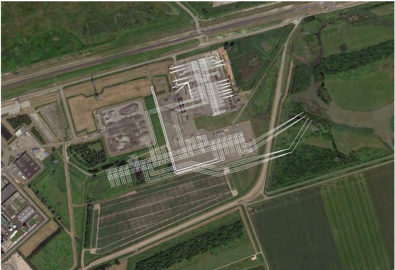
Figuur 3 Variant 3, station Borssele met volledige verlenging 380 kV rails en hoogspanningslijn BSL-RLL Zwart/Grijs
