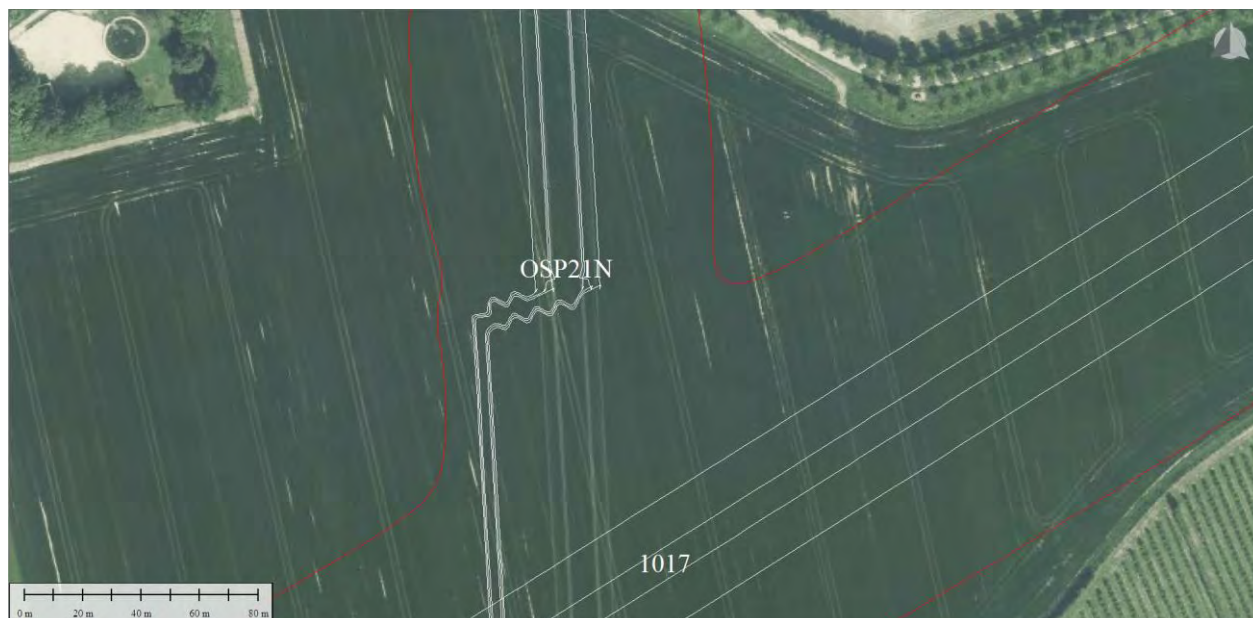
Figuur 2: Weergave omhullende 0,4 microtesla magneetveldcontour opstijgpunt 21N
