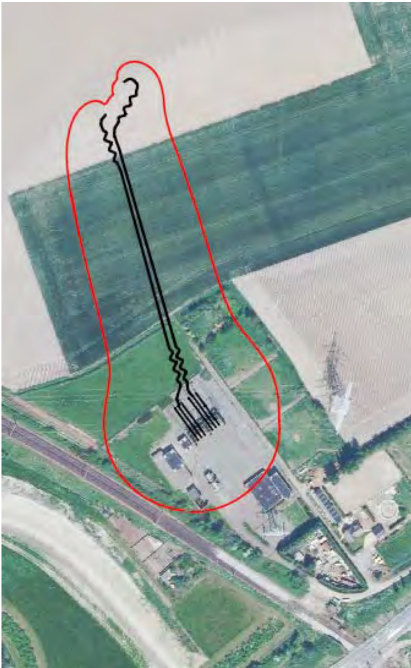
Figuur 3: Weergave "Cumulatieve magneetveld" 0,4 microteslacontour station Kruiningen (150kV) na aanpassing
