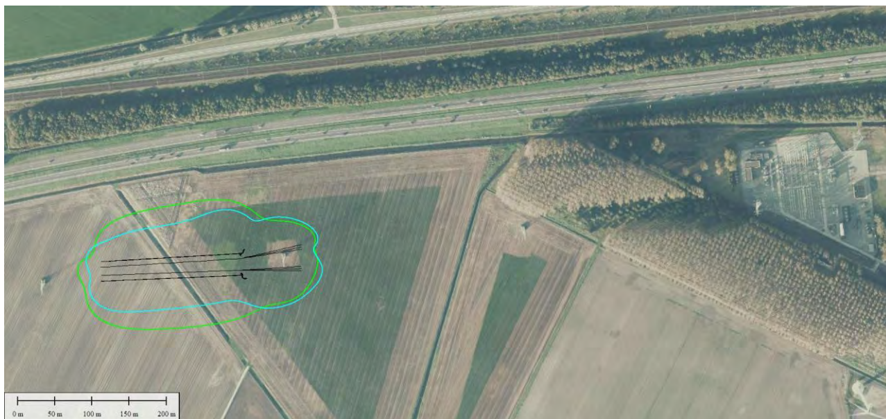
Figuur 4: Weergave alle contouren "Cumulatieve magneetveld" 0,4 microtesla opstijgpunt 1104
