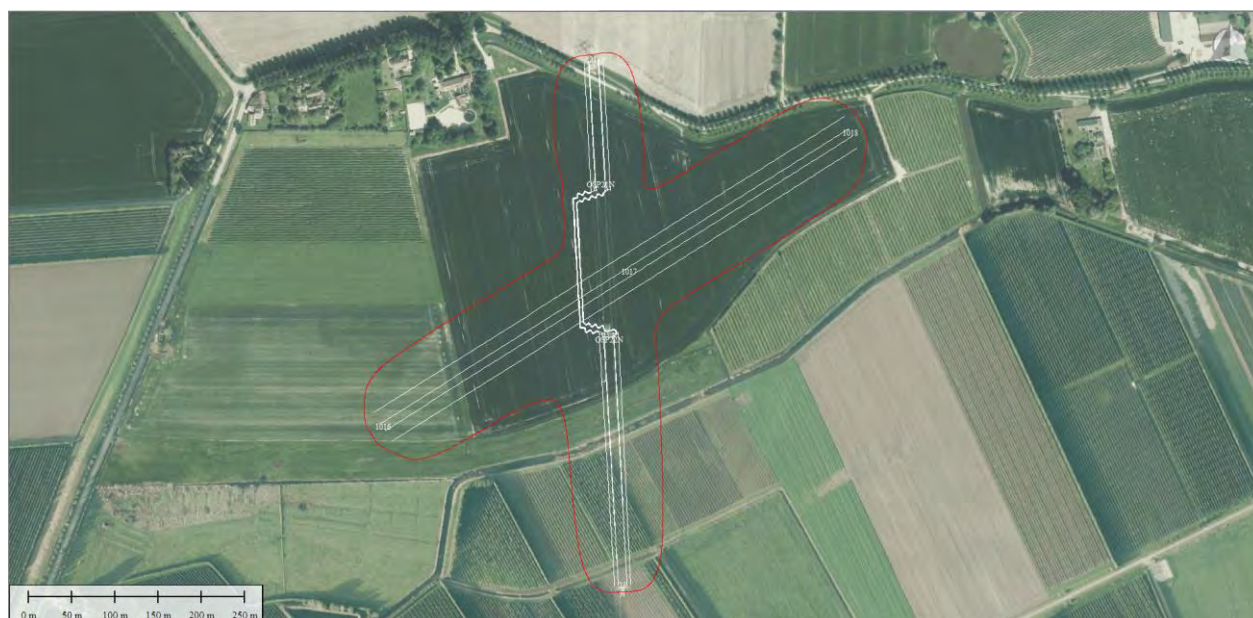
Figuur 3: Weergave omhullende 0,4 microtesla magneetveldcontour nabij opstijgpunt 21N
