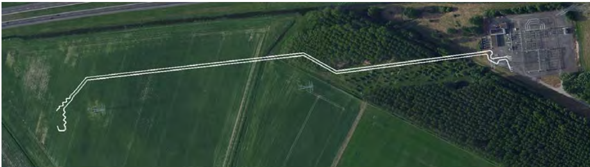
Figuur 1 Schematisch overzichtssituatie nieuwe 150 kV-kabelverbinding "Rilland West".
