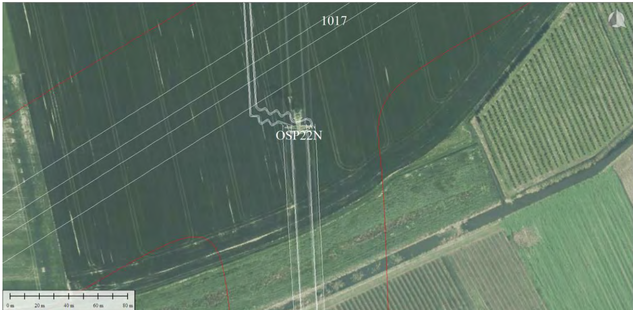
Figuur 2: Weergave omhullende 0,4 microtesla magneetveldcontour opstijgpunt 22N
