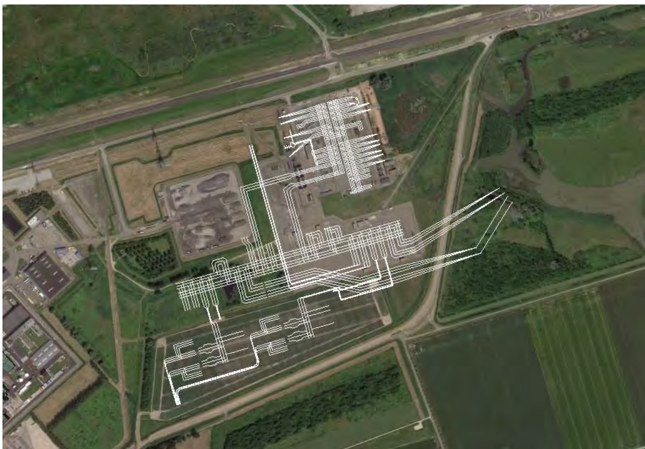
Figuur 4 Variant 4, station Borssele met volledige railverlenging en OHL BSL-RLL Z/G. Ook het Net op Zee station is inbegrepen.
