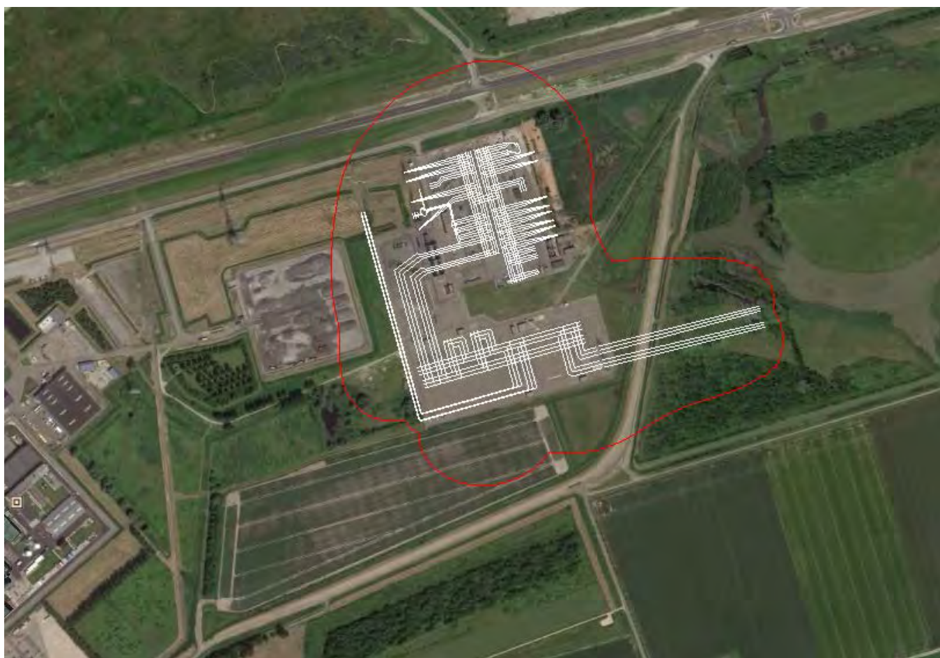
Figuur 5 "cumulatieve magneetveld" 0,4 microtesla contour station Borssele (380/150 kV) in de oorspronkelijke toestand
