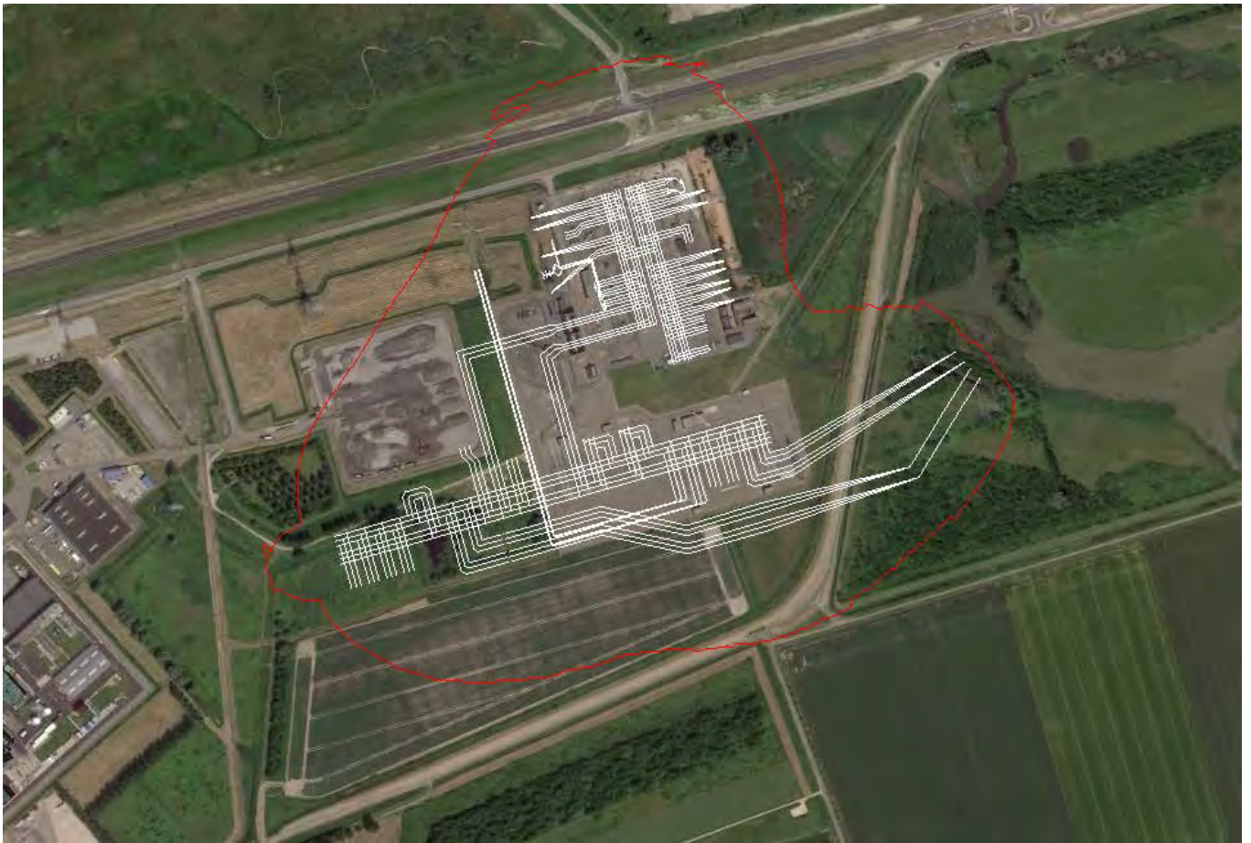
Figuur 7 "cumulatieve magneetveld" 0,4 microtesla contour station Borssele na volledige railverlenging en toevoeging OHL BSL-RLL Z/G
