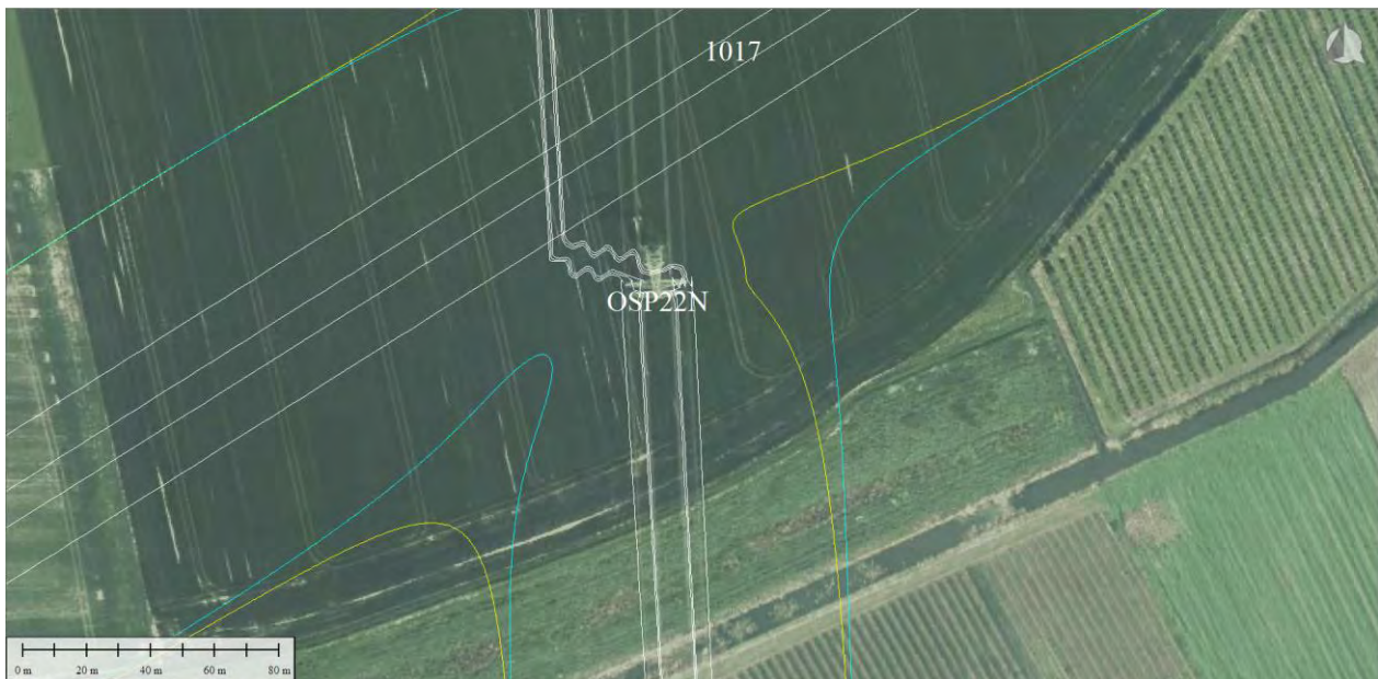
Figuur 4: Weergave 0,4 microtesla magneetveldcontouren opstijgpunt 22N
