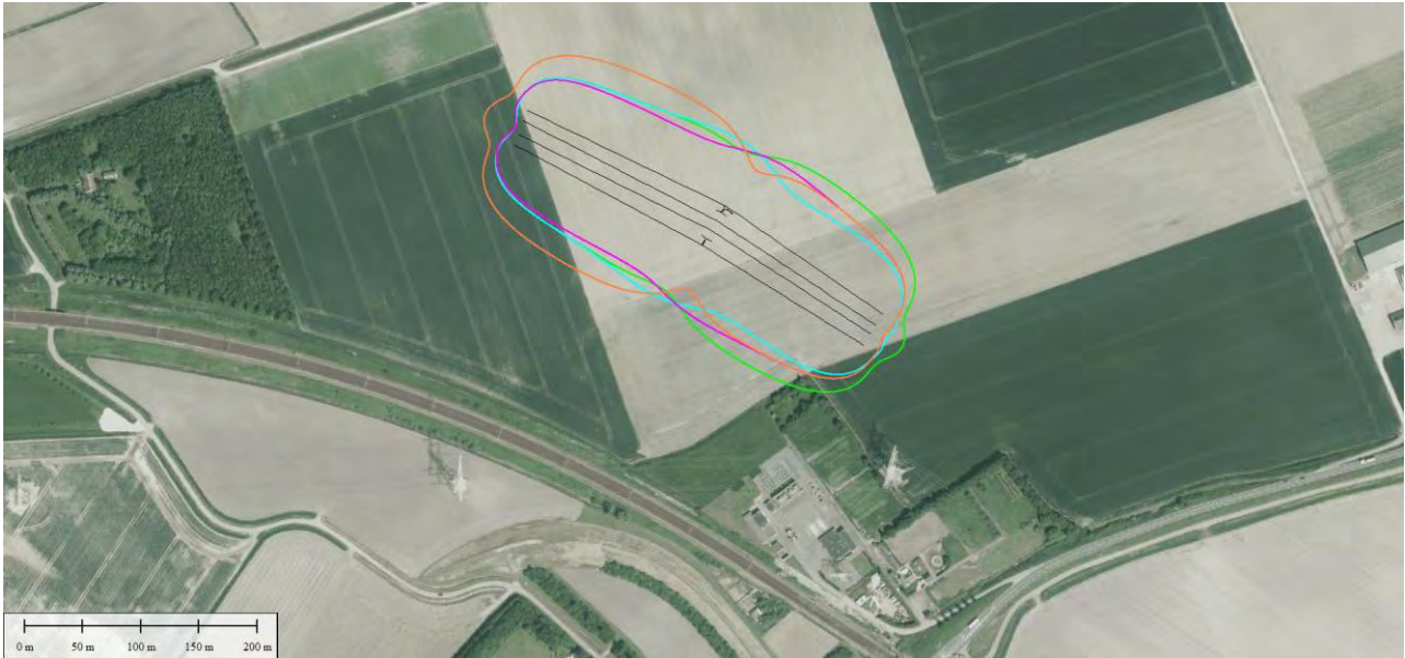
Figuur 4: Weergave alle contouren "Cumulatieve magneetveld" 0,4 microtesla opstijgpunt 1066
