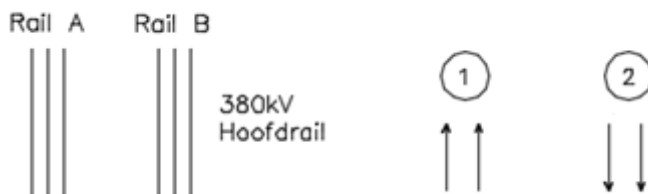
Figuur 10 Berekende situaties van stromen door de 380 kV hoofdrails in het Net op Zee station
