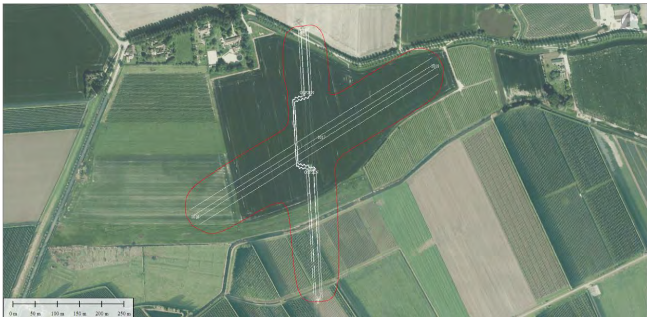
Figuur 3: Weergave omhullende 0,4 microtesla magneetveldcontour nabij opstijgpunt 22N
