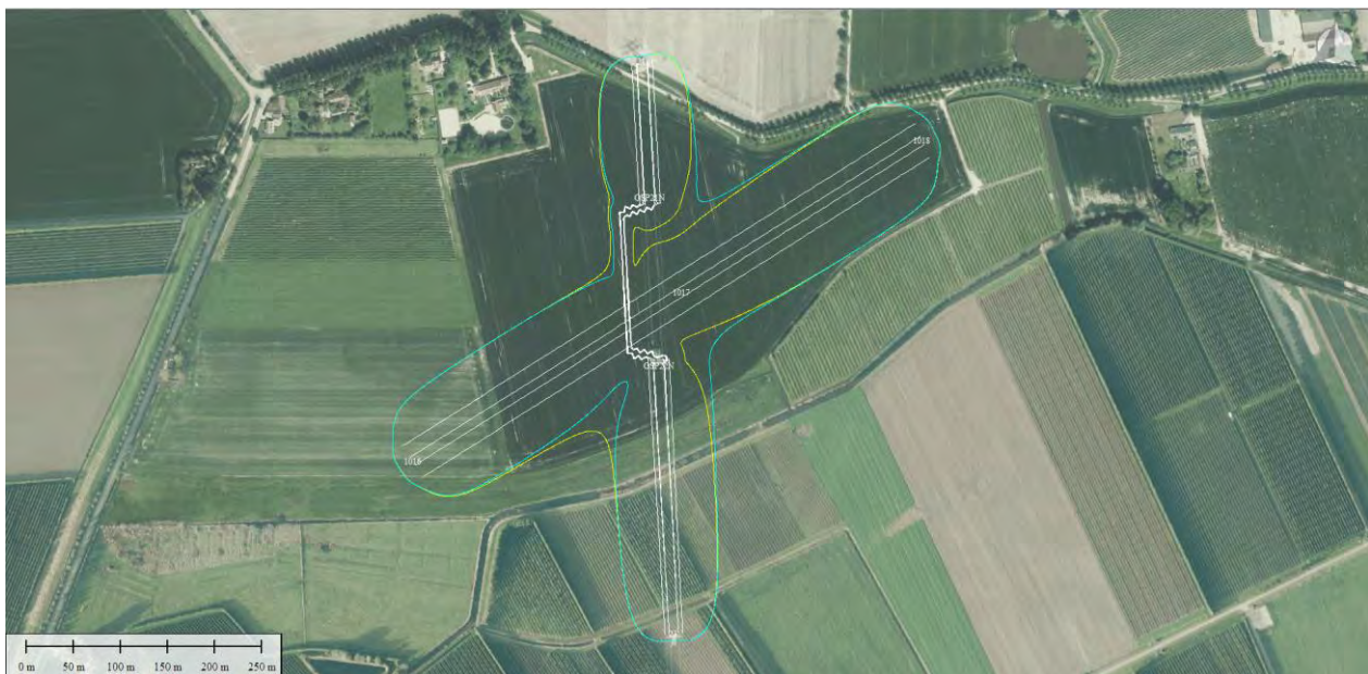
Figuur 5: Weergave 0,4 microtesla magneetveldcontour nabij opstijgpunt 21N
