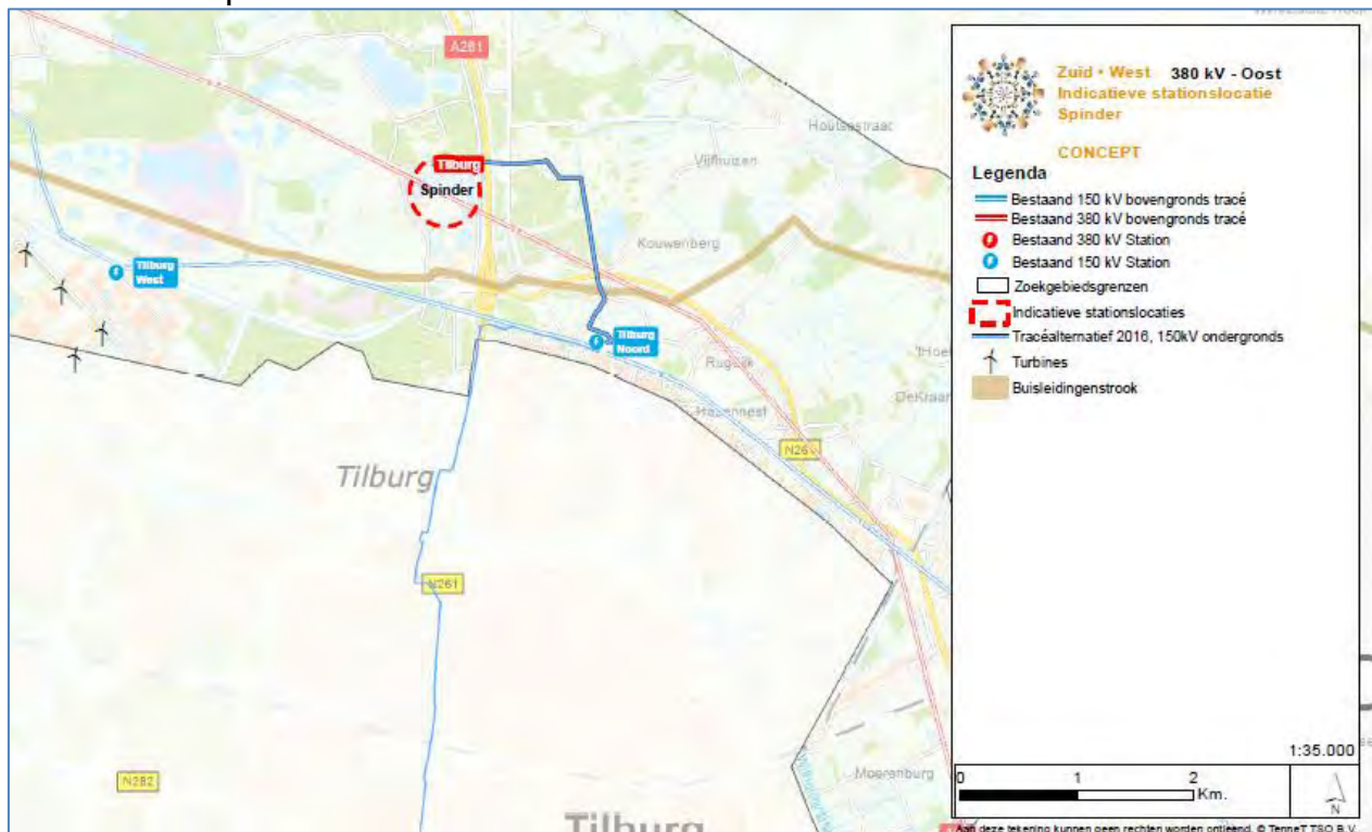
Figuur 67 Locatie Spinder inclusief 150kV kabeltracé
