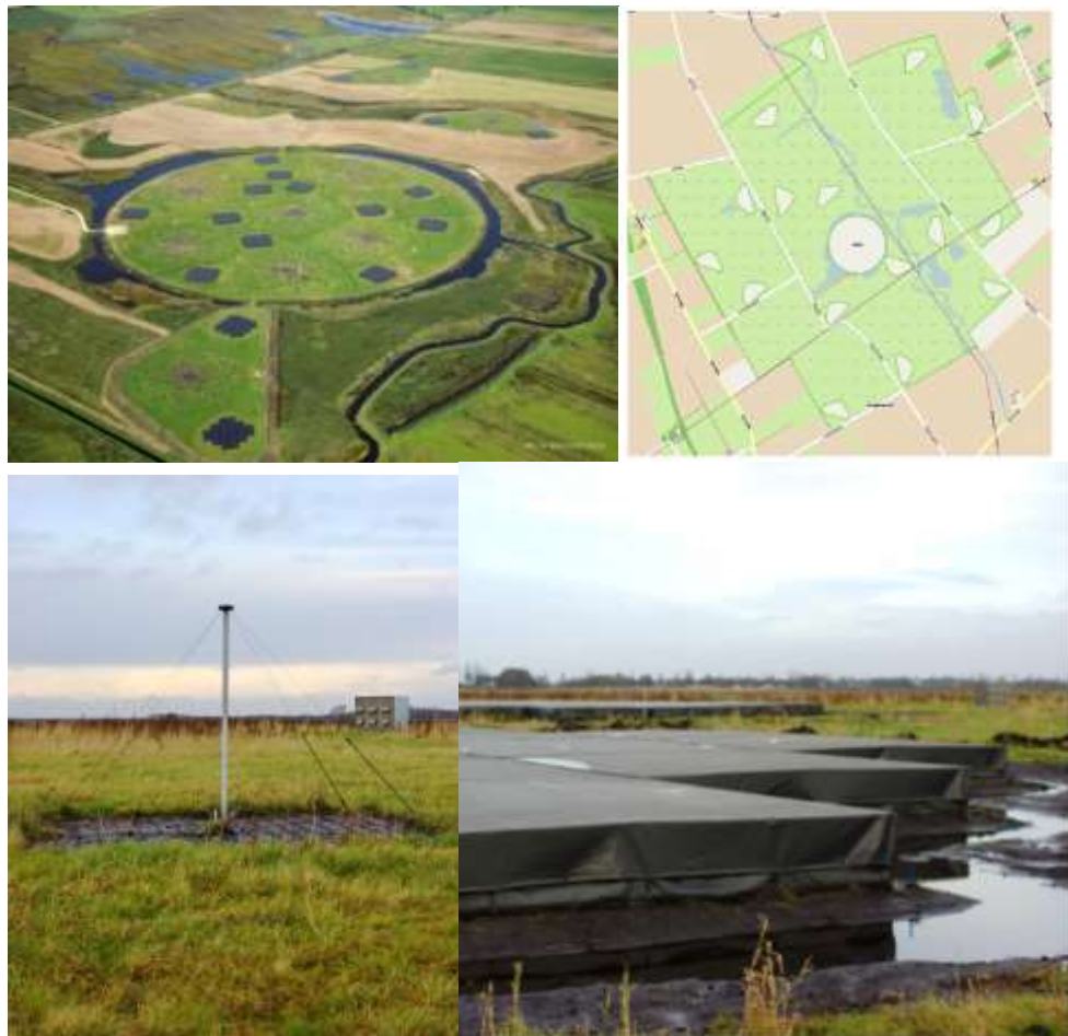
Figuur 1: Boven-links: LOFAR superterp; boven-rechts: de LOFAR kern ('core'), de cirkel geeft de superterp weer met daaromheen nog een aantal stations. Onder-links: antenne voor de 'lage band' (30-80 MHz) en onder-rechts: voor de 'hoge' band (120-250 MHz). Bron: LOFAR website [11].
