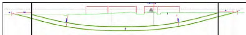
Figuur 3 Methode 'gestuurde boring': zijaanzicht met de ligging van de kabels op twee diepten 2
