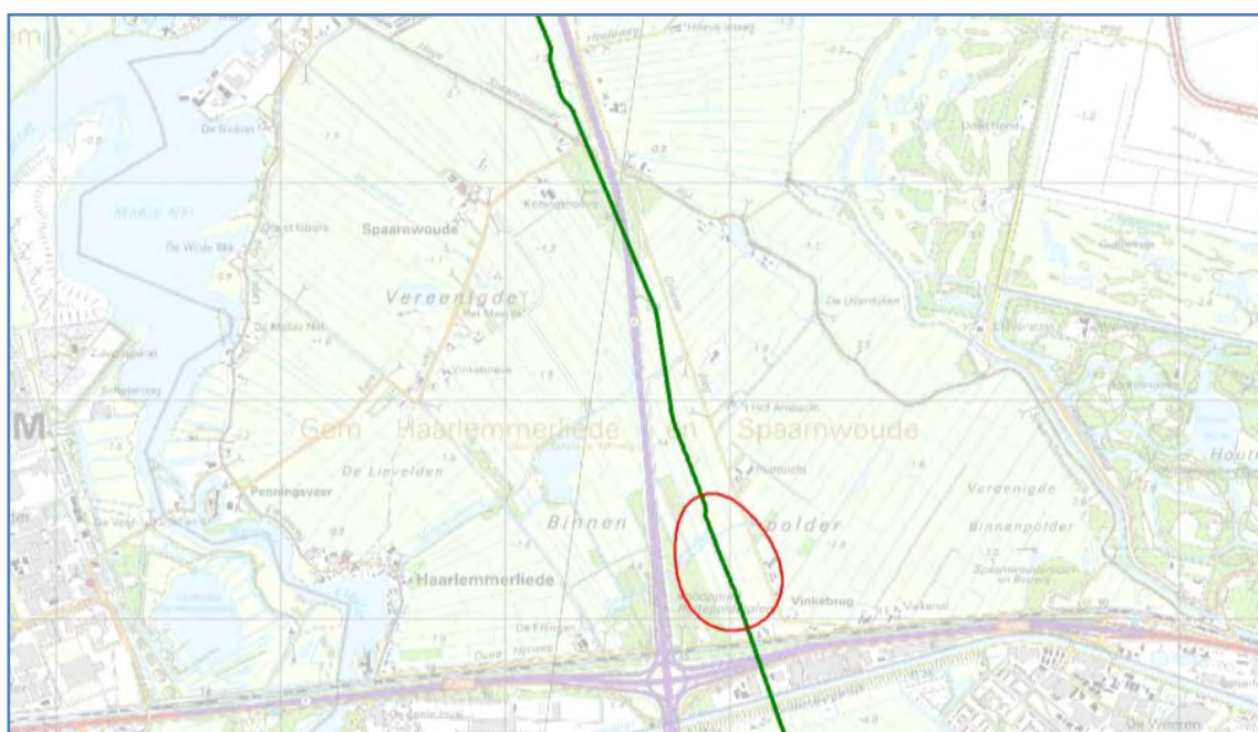
Figuur 2: Plaatsgebonden risicocontour van 10^{-6} /jaar, noordelijk van de Noordelijke Ringvaart. Door de 'slappe grond' dringen vliegtuigen zodanig in de grond, dat de leiding op 1,6m diepte geraakt wordt.
