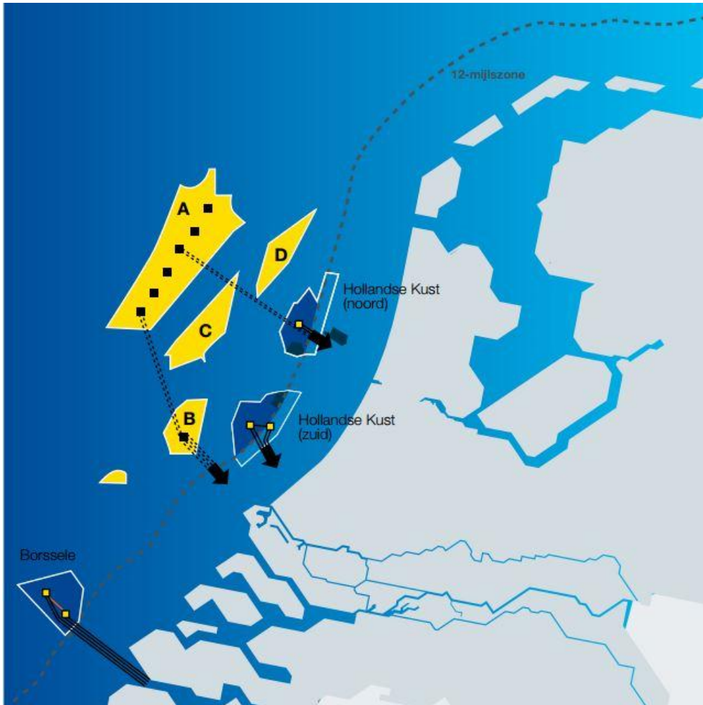
Afbeelding 2.7 Schematische weergave windenergiegebieden met illustratieve route van de kabels voor de netaansluiting
