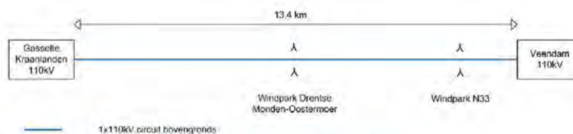
Figuur 1 Schematisch overzicht 110kV verbinding Gasselte Kraanlanden - Veendam
