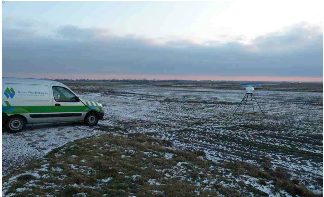
Figuur 2.1 Opstelling horizontale radar (Furuno 12 kW) op de avond van 8 februari 2012 op locatie Nieuw Buinen in de Drentse Monden.
