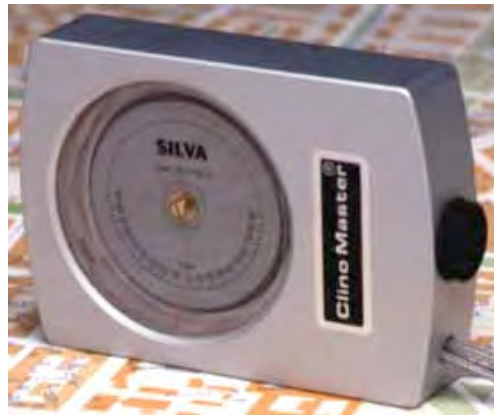
Figuur 2.3 Inclinometer waarmee hoeken ten opzichte van de horizon kunnen worden bepaald om de waarneemstripbanden af te bakenen.
