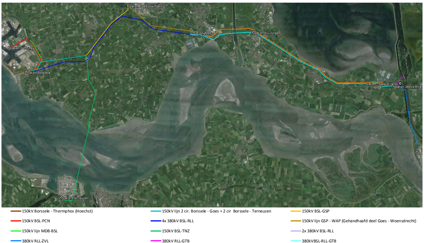
Afbeelding 1 Plangebied met deeltracé 1 en 2 van de nieuw te bouwen 380kV lijn ZW380 en de bestaande hoogspanningslijnen.
