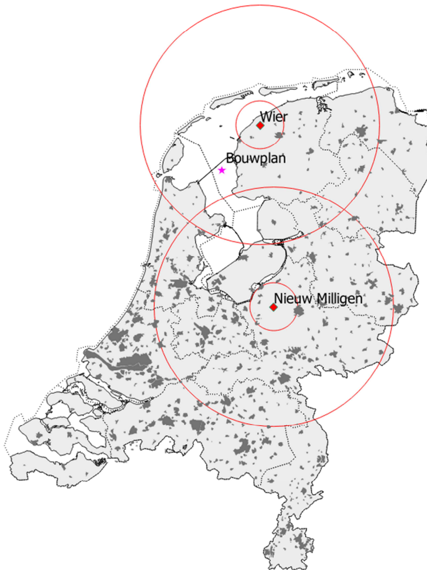
Figuur 4. Locaties van de twee MPR gevechtsleidingsradars (rode ruit) met daaromheen de 15 en 75 km cirkels. De donkergrijze vlakken zijn de in de AHN-1 gedefinieerde stedelijke gebieden. De ligging van het te toetsen bouwplan is aangegeven met een roze ster.
