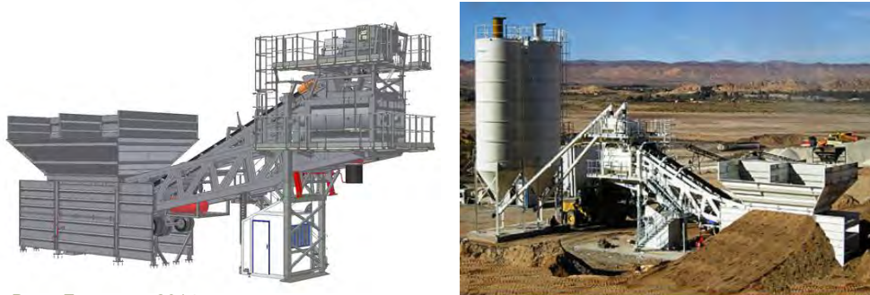
Figuur 2.16 Voorbeeld mobiele betoncentrale (Frumeccar 2000)
