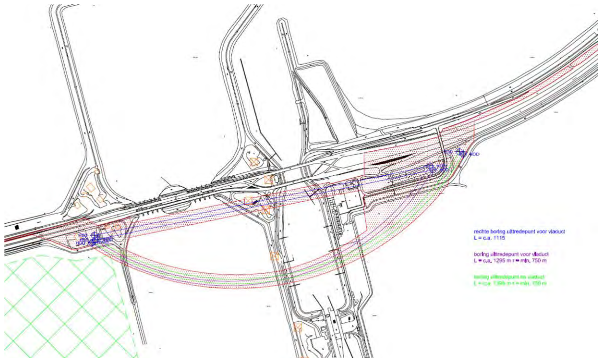
Figuur 2-7: Twee opties voor de HDD-boring van kabels bij Kornwerderzand. Er is gekozen voor de ruime boog om de effecten op bebouwing te beperken en vanwege toekomstige reserveringen van Rijkswaterstaat
