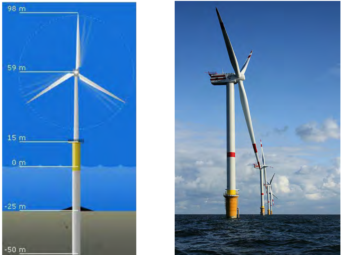
Figuur 6-9 Links: afmetingen van een paal in het Prinses Amalia park (foto van website: www.prinsesamaliawindpark.eu ; Rechts: foto van de 5MW turbines op de Thornton Bank
