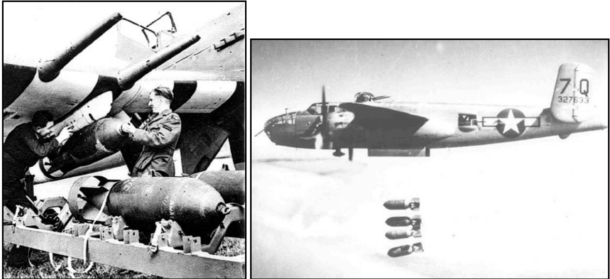
Figuur 44: Links bevestigen van een 500 lbs bom onder een Britse Typhoon jachtbommenwerper en rechts een B-25 Mitchell bommenwerper die bommen afwerpt.
