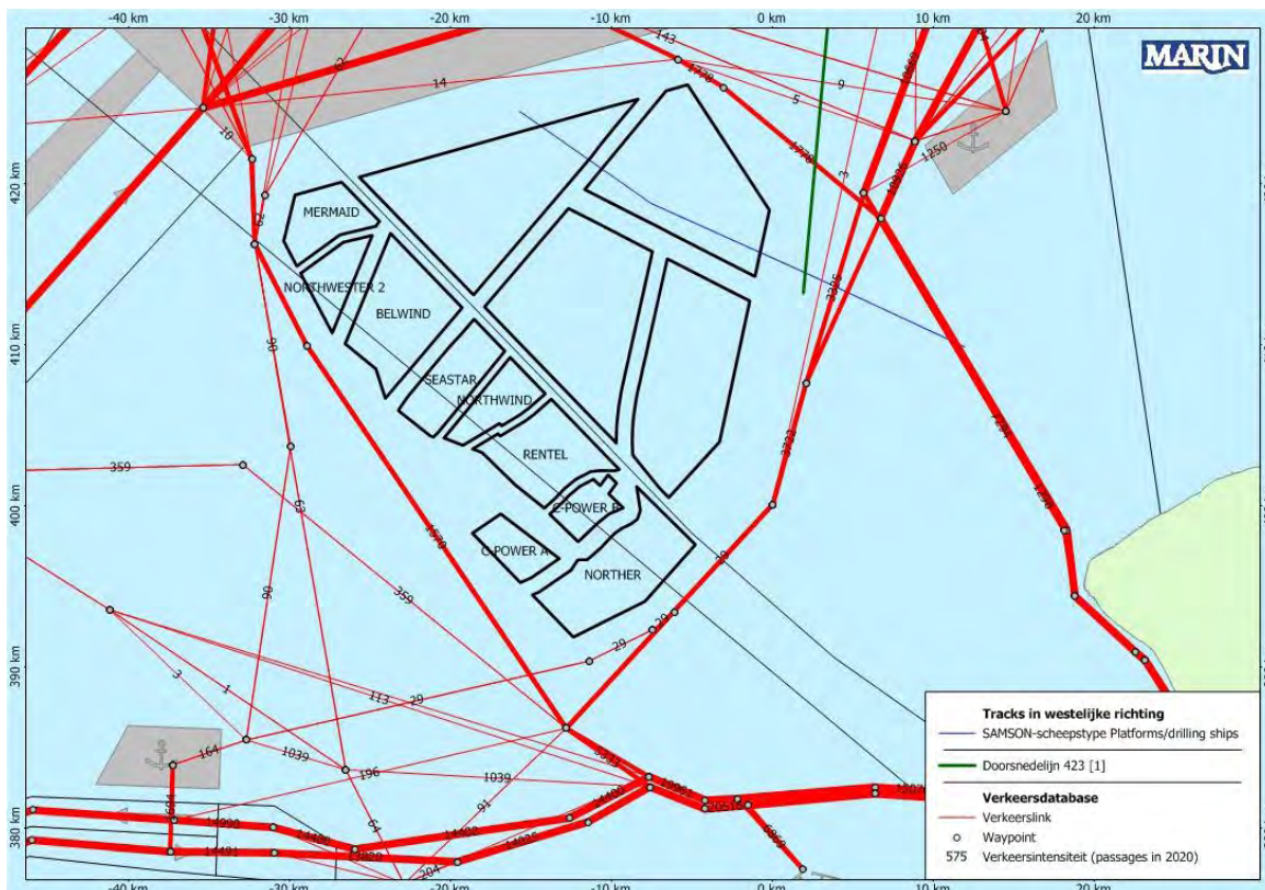
Figuur 10 Tracks van platforms/boorschepen rondom Borssele behorend bij de passages van doorsnedelij 423 in westelijke richting in de periode augustus 2013 t/m juli 2014 [1]
