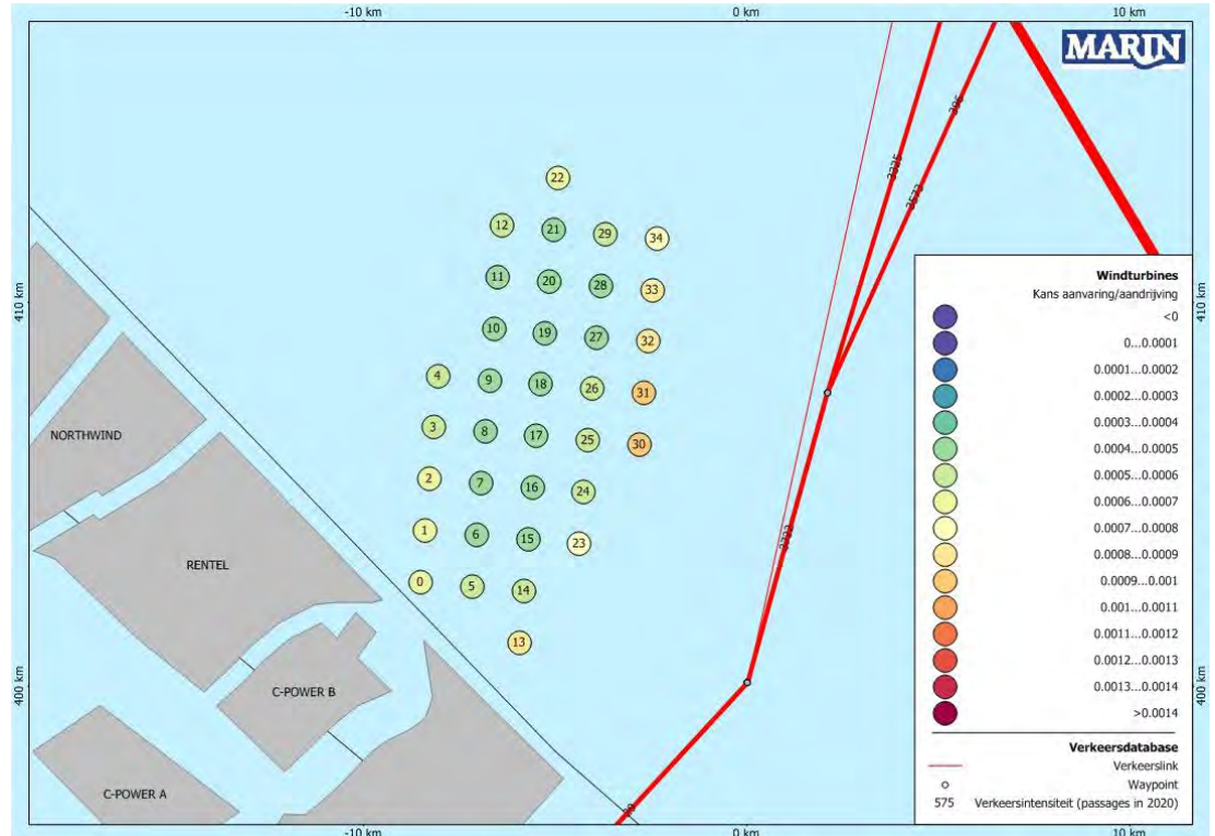
Figuur B2-1 Lay-out en aanvaar- en aandrijfkansen turbines windpark Borssele Kavel II variant 2 (10MW)
