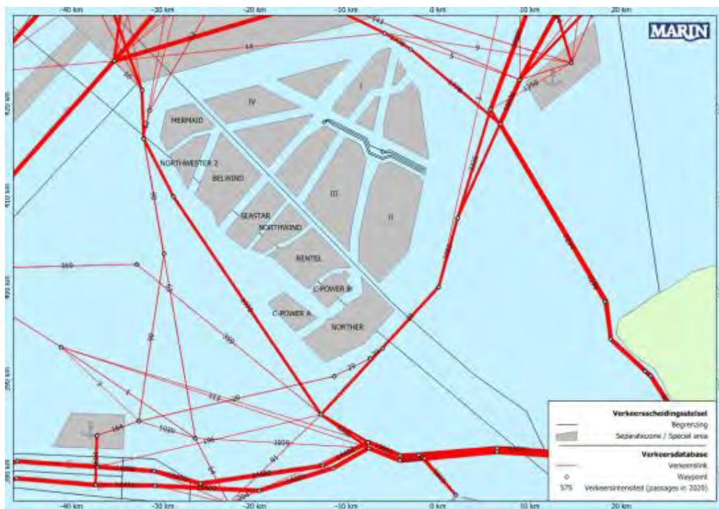
Figuur 8.4 Verkeerssituatie voor het scenario (2020) waarin kavels I en II zijn afgesloten voor het verkeer, net als het windenergiegebied aan Belgische zijde
