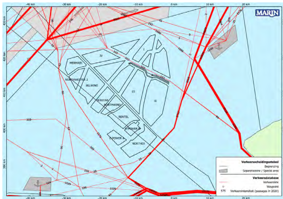
Figuur 4-5 Verkeersdatabase voor 2020 voor verkeersscenario D waarbij schepen tot 80 meter, m.u.v. schepen van het type Chemical, LPG, LNG en Oil, worden toegelaten tot de oost-westcorridor
