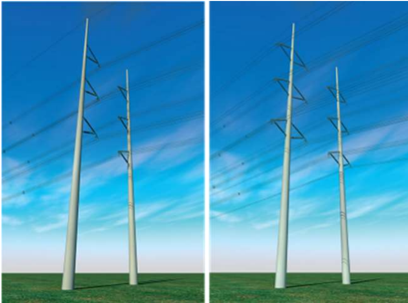
Afbeelding 10 380kV solomast (links) en combinatiemast 150kV en (4 x) 380kV (rechts).
