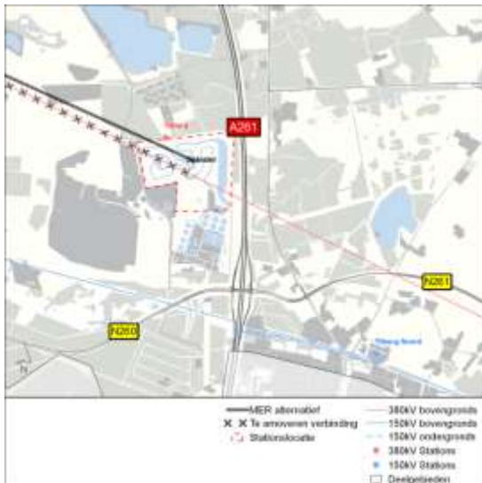
Afbeelding 70 Spinder: locaties en verbindingen bij de alternatieven C150b, C380 en C150n. Dikke lijn: nieuwe verbinding, dunne lijn: 150kV-kabel (indicatief); kruisjes: te amoveren bestaande lijn
