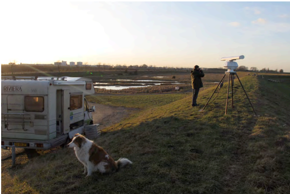
Figuur 2.2 Opstelling horizontale radar (Furuno 12 kW) op de avond van 24 februari 2010 op de dijk ter hoogte van de Kaarspolder.
