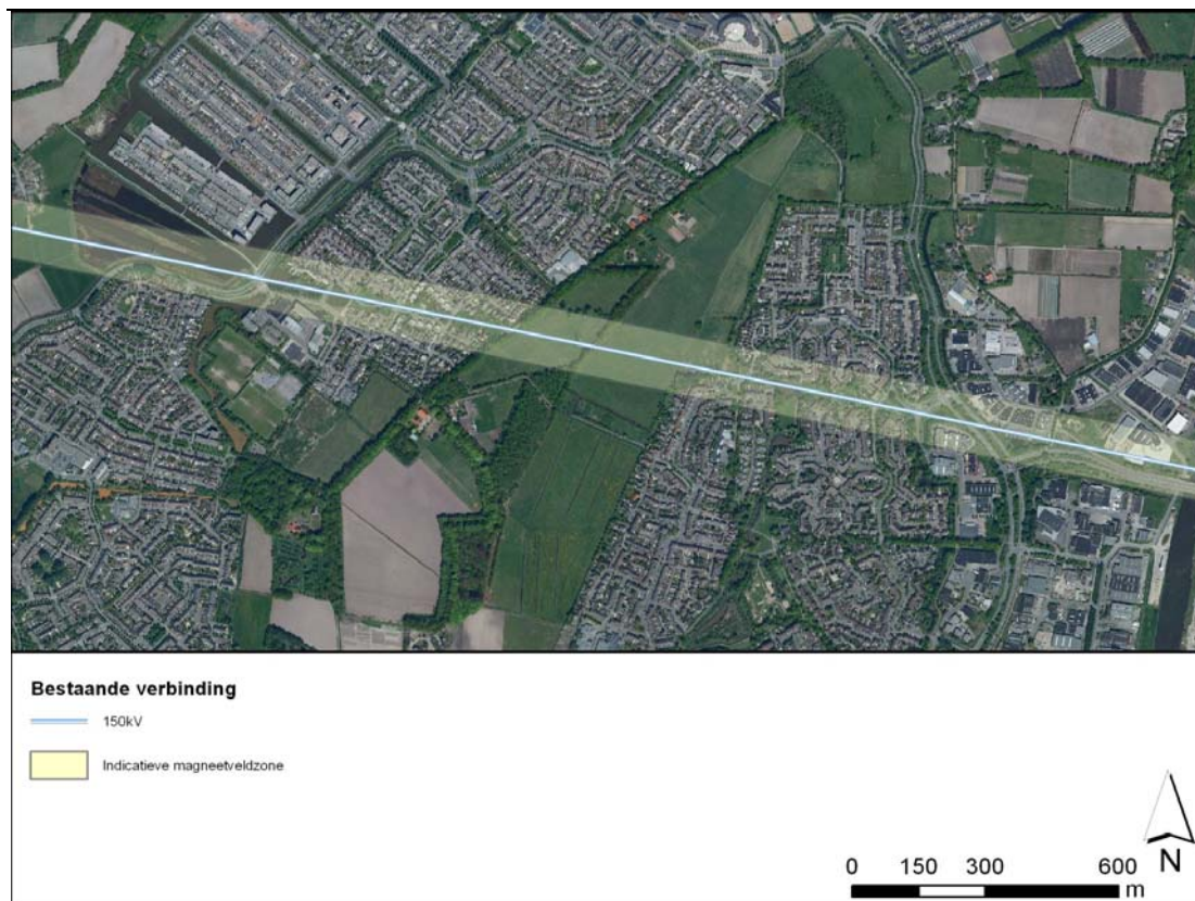
Figuur 6.5 Doorsnijding bestaande 150 kV-verbinding door Breda-Noord
