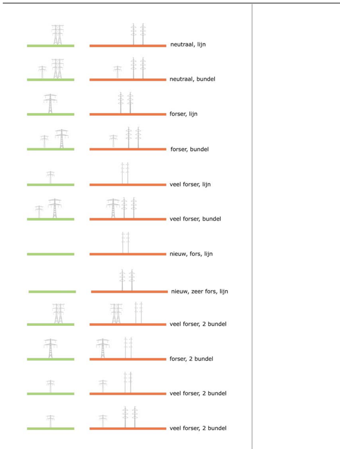
Figuur 4.6 Voorkomende lijncombinaties en forsheid (links met groen grondvlak de bestaande situatie, rechts met oranje grondvlak de nieuwe situatie)
