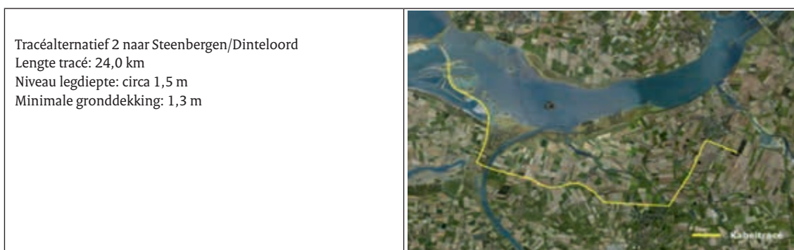
Figuur 2.9 Tracéalternatief 2: Transformatorstation Steenberg/Dinteloord
