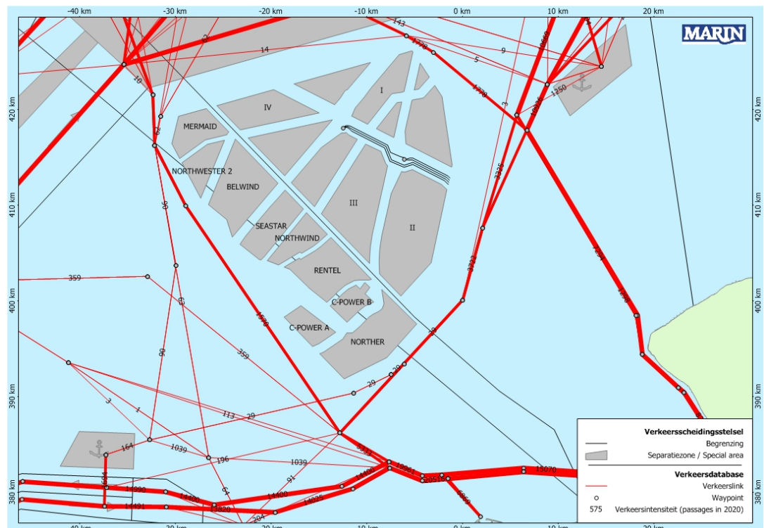
Figuur 4-2 Verkeerssituatie voor 2020 voor het scenario waarin kavels I, II, III en IV van windenergiegebied Borssele afgesloten zijn voor verkeer, net als het windenergiegebied aan de Belgische zijde.
