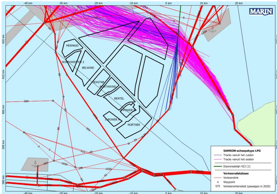
Figuur 6 Tracks van LPG-schepen rondom Borssele behorend bij de passages van doorsnedelij 423 in westelijke richting in de periode augustus 2013 t/m juli 2014 [1]
