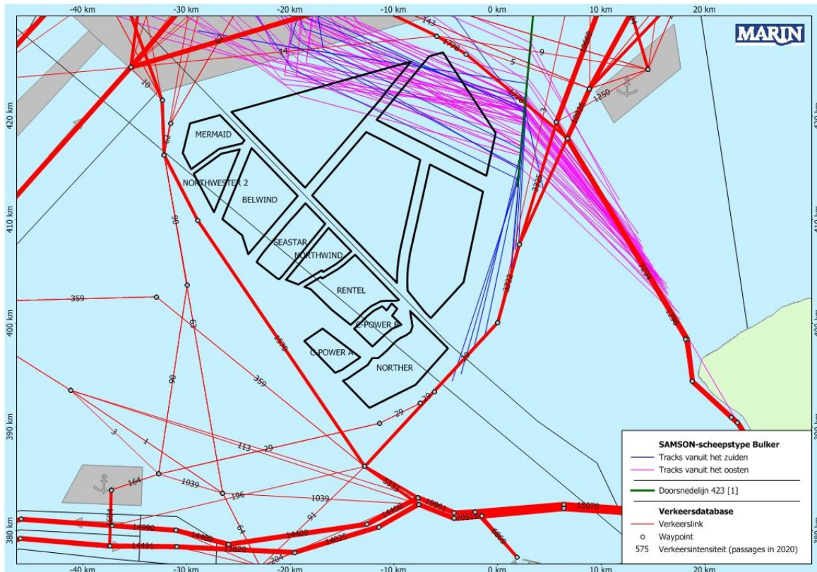
Figuur 2 Tracks van bulkerschepen rondom Borssele behorend bij de passages van doorsnedelij 423 in westelijke richting in de periode augustus 2013 t/m juli 2014 [1]
