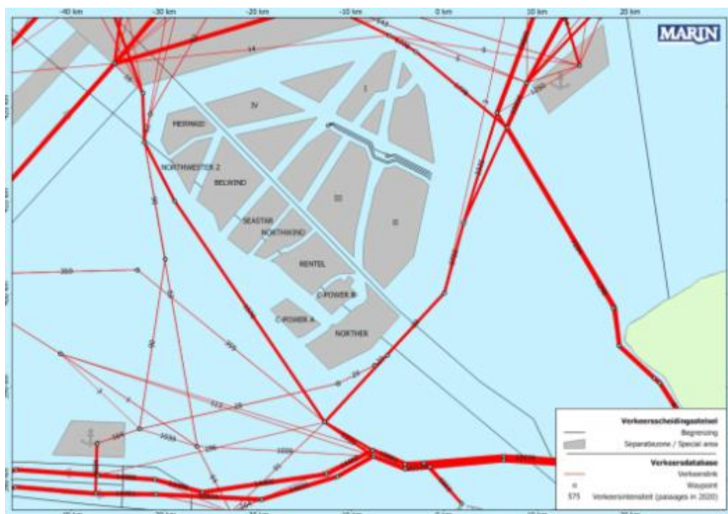
Figuur 8.4 Verkeerssituatie voor het scenario (2020) waarin kavels I, II, III en IV zijn afgesloten voor het verkeer, net als het windenergiegebied aan Belgische zijde
