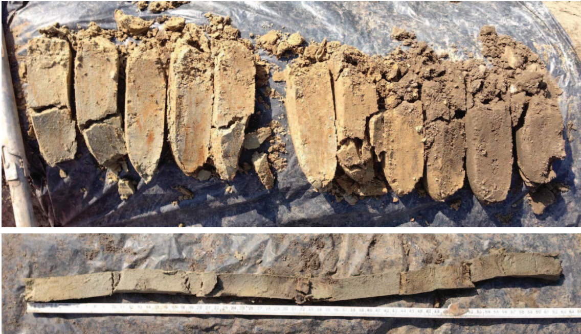
Figuur 9: Kruiningen - Boring 3: totaaloverzicht boorkernen.
