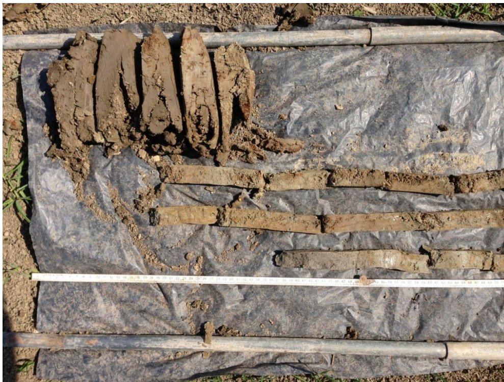
Figuur 2: Willem-Annapolder - Boring 2: totaaloverzicht boorkernen.
