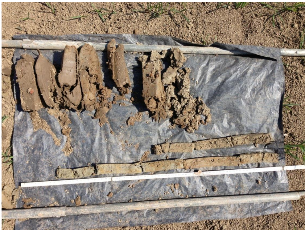
Figuur 2: Willem-Annapolder - Boring 2: totaaloverzicht boorkernen.
