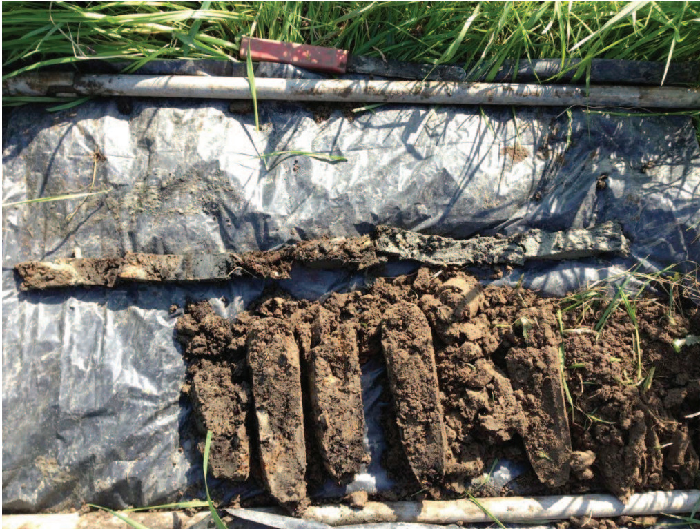
Figuur 11: Kruiningen - Boring 5: totaaloverzicht boorkernen.
