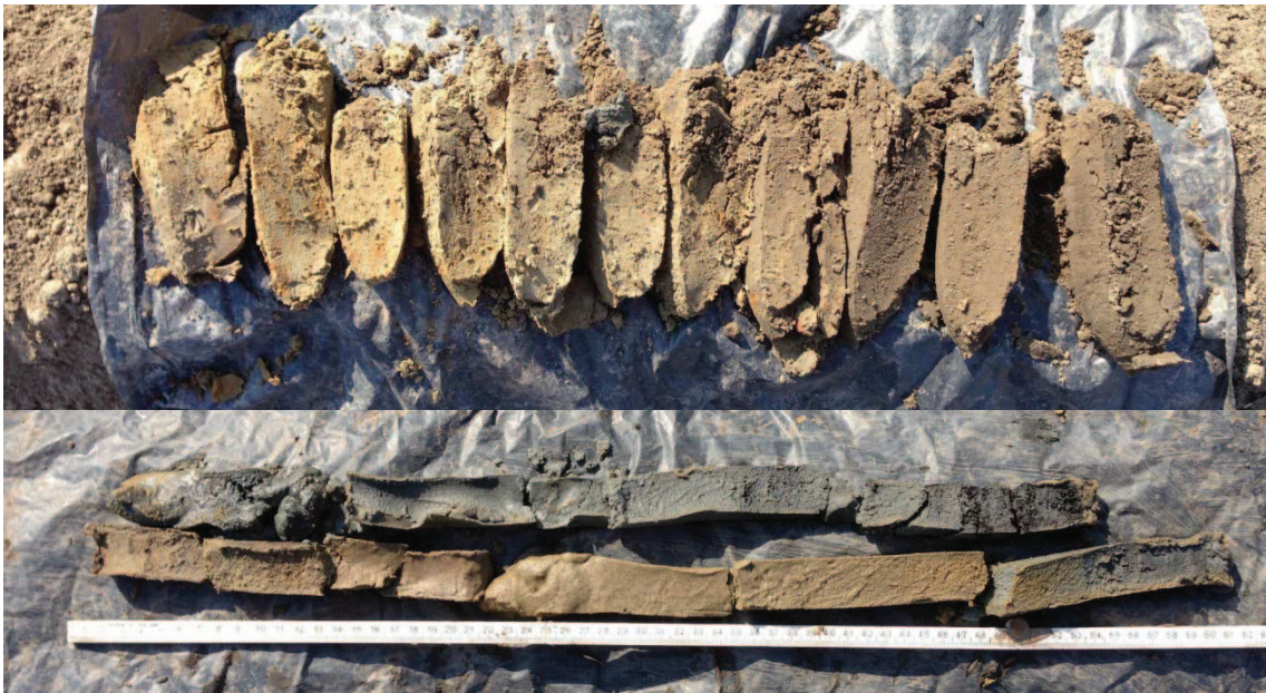
Figuur 10: Kruiningen - Boring 4: totaaloverzicht boorkernen.
